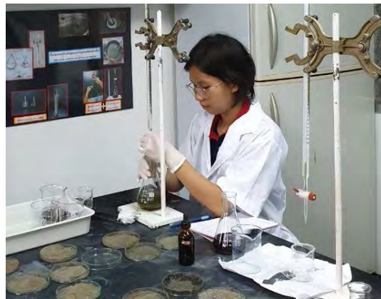
การวิเคราะห์หาปริมาณอินทรีย์สารด้วยวิธี Hydrometer method (Bouyoucos, 1962)
