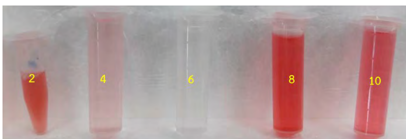
รูปที่ 4.15 แสดงผลการทดลองตัวแปร pH ของสีย้อมคองโกเรด
