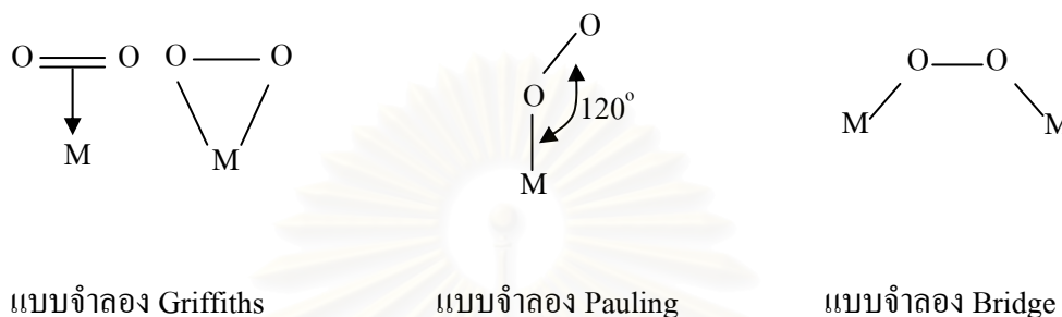
รูปที่ 2.9 แบบจำลองของออกซิเจนบนพื้นผิวตัวเร่งปฏิกิริยาของโลหะชนิดต่าง ๆ [Kinoshita, 1992]
