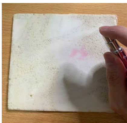
รูปที่ 3.1 การฉีดสารละลายแอมโมเนียผสมกับฟีนอล์ฟทาลีนลงบนโฟมยางธรรมชาติ
