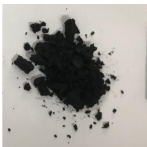
รูปที่ 3. ผงของแบตเตอรี่สังกะสีคาร์บอนที่ใช้แล้ว
