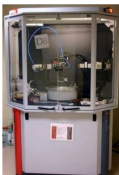
รูปที่ 3.4 เครื่องเอ็กซ์เรย์-ดิฟแฟกซ์โตรมิเตอร์
