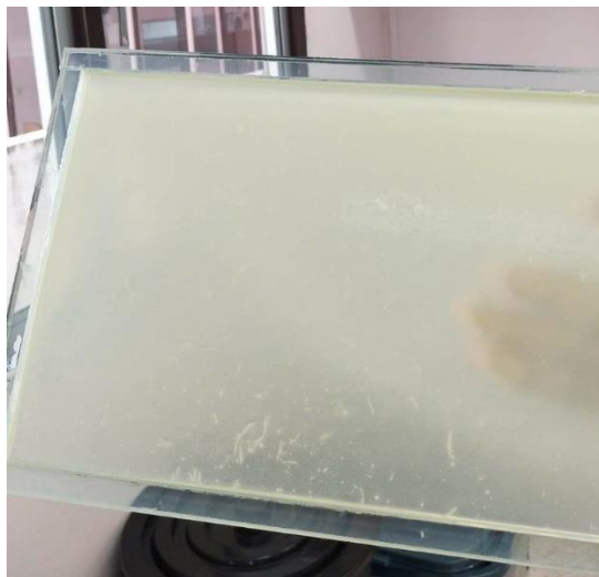
ภาพที่ 5 แผ่นยางที่เตรียมได้จากยางธรรมชาติผสมกับน้ำเยื่อที่ไม่ได้กรองผ่านตะแกรงก่อนแห้งตัว
