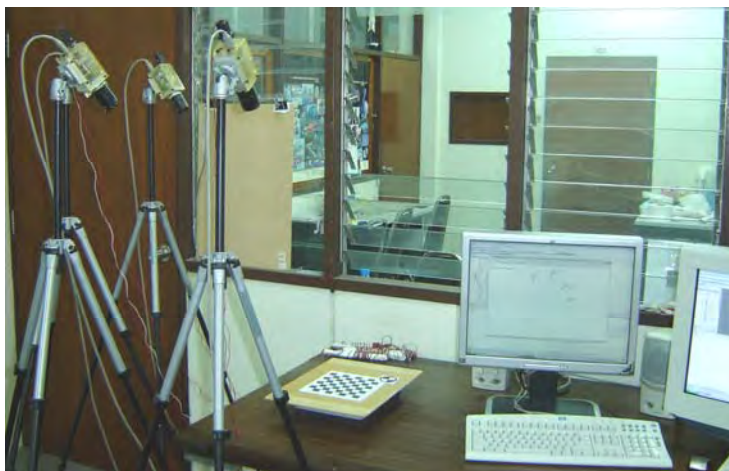
รูปที่ 4.1 การติดตั้งอุปกรณ์เพื่อสอบเทียบระบบกล้องด้วยกระดานสอบเทียบ
