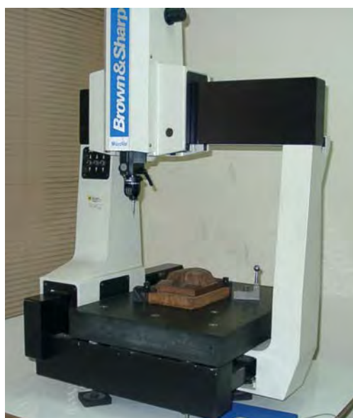
รูปที่ 2.8 เครื่องวัดพิกัด 3 มิติแบบสัมผัสยี่ห้อ Brown & Sharpe รุ่น Microval 343
