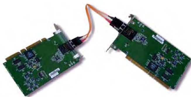
รูปที่ 2.4 แผงวงจรสำหรับเคลื่อนย้ายข้อมูลระหว่างบัสพีซีไอที่เชื่อมต่อกันผ่านสายใยนำแสง
