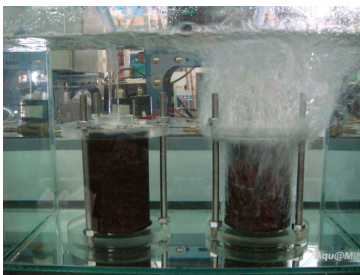
รูปที่ 3.3 การวางหัวกระจายอากาศแบบเซรามิคในถังปฏิบัติการ
