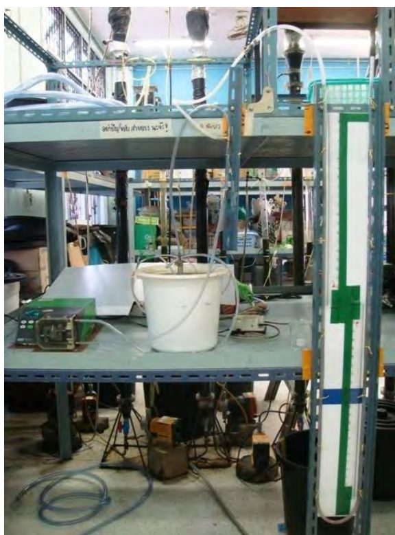
รูปที่ 3.10 ชุดทดลองการหาค่าความดันผ่านเมมเบรนที่เปลี่ยนแปลงตามระยะเวลาในการสูบกรองที่ค่าความเข้มข้นตะกอนจุลินทรีย์ต่างๆ
