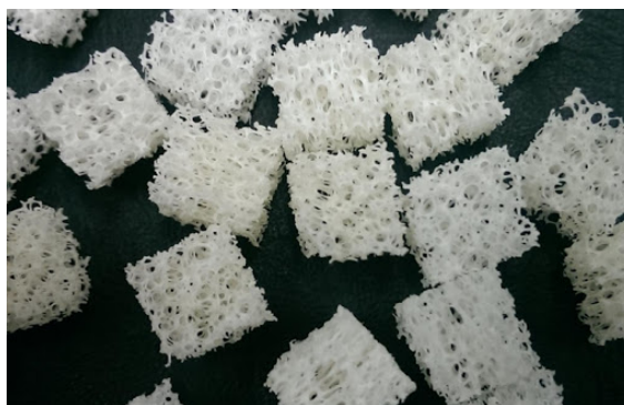
รูปที่ 3.4 วัสดุสังเคราะห์ที่มีรูพรุนสำหรับตรึงเชื้อจุลินทรีย์ Aquaporous gel
