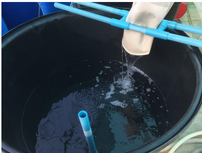
ภาพที่ 3-2 การกรองน้ำทะเลเพื่อกำจัดสารแขวนลอยผ่านถุงกรองขนาด 5 ไมครอน
