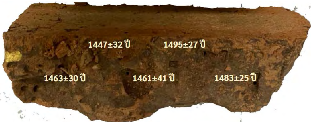
รูป 4.4. ตัวอย่างอิฐ PHG01 พร้อมกับแสดงค่าอายุในบริเวณทั่วทั้งก้อน
