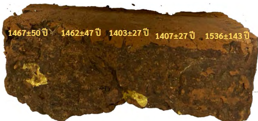
รูป 4.5. ตัวอย่างอิฐ PHG02 พร้อมกับแสดงค่าอายุในบริเวณเนื้อขอบนอก
