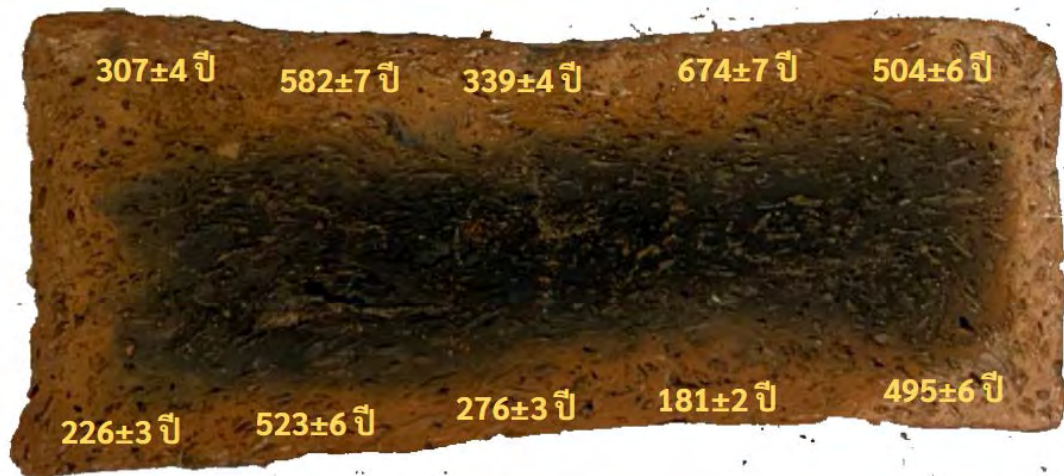
รูป 4.3. ตัวอย่างอิฐ PH02 พร้อมกับแสดงค่าอายุในบริเวณเนื้อขอบนอกที่ค่อนข้างแปรปรวน
