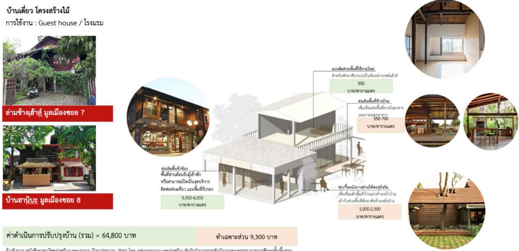
ภาพที่ 49 การปรับปรุง ดัดแปลงบ้านเดี่ยวโครงสร้างไม้ ที่มา : จัดทำโดยผู้วิจัย
