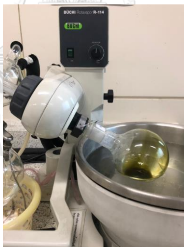
รูปที่ จ.2 การระเหยเอทานอลออกจากสารสกัดจากใบเจียวกู่หลานด้วยเครื่อง rotary evaporater
