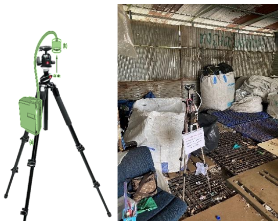
รูปที่ 12 แสดงตัวอย่างการติดอุปกรณ์เก็บฝุ่นฯ กับขาตั้งอุปกรณ์ (เก็บตัวอย่างแบบ Area sampling)
