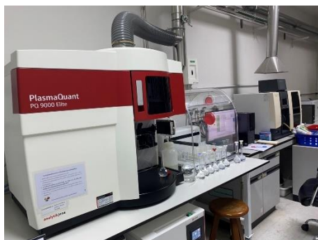
รูปที่ 6 เครื่องวิเคราะห์ธาตุโลหะหนัก ICP-OES และหลักการทำงานของเครื่อง
