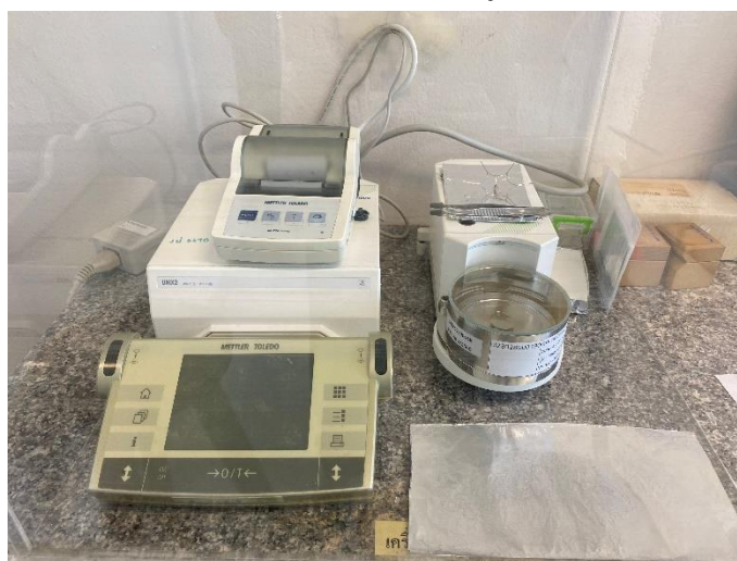
รูปที่ 5 เครื่องชั่งน้ำหนัก 7 ตำแหน่งแบบสนามแม่เหล็กไฟฟ้า (electromagnetic coil)
