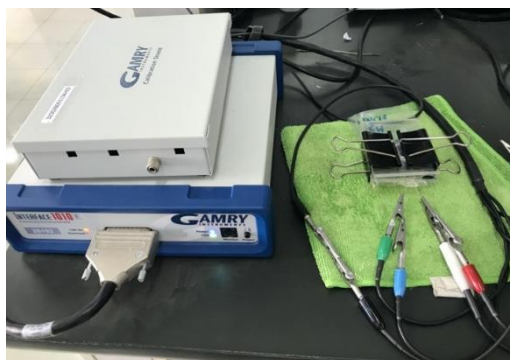
รูปที่ 3.6 ตัวอย่างการวัดค่าความต้านทานด้วยเครื่อง Interface 1010E Potentiostat
