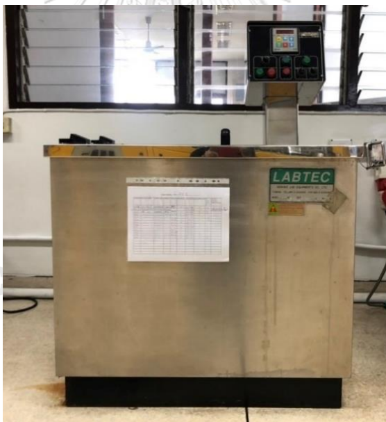
รูปที่ 3.1 เครื่องย้อมผ้าแบบ exhaustion ยี่ห้อ Labtec
