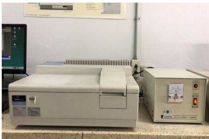
รูปที่ 3.9 เครื่อง UV-vis spectrophotometer ยี่ห้อ Perkin Elmer รุ่น LAMBDA 35
