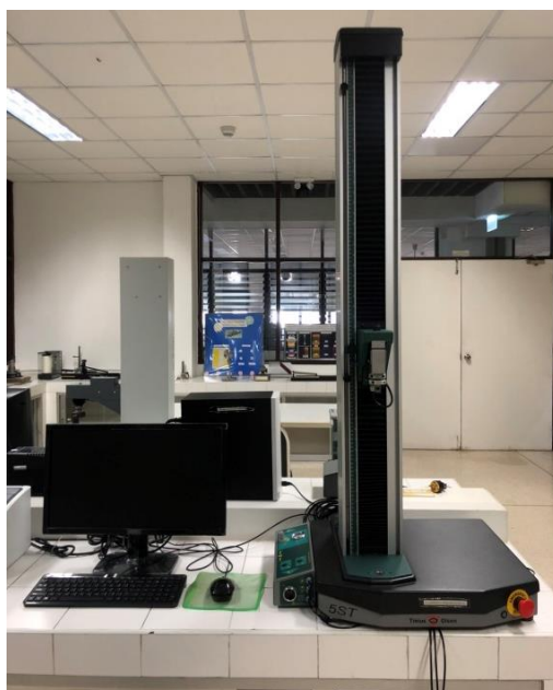
รูปที่ 3.7 เครื่องทดสอบความแข็งแรงของผ้า ยี่ห้อ Tinuis Olsen
