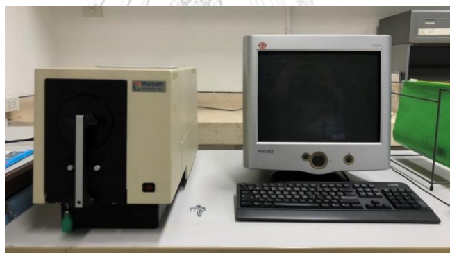
รูปที่ 3.5 เครื่องทดสอบการวัดสีผ้า ยี่ห้อ Macbeth Color-Eye 7000
