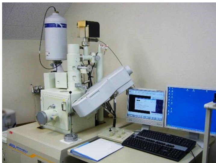
รูปที่ 3.6 กล้องจุลทรรศน์อิเล็กตรอนแบบส่องกราด ยี่ห้อ Jeol รุ่น JSM-6480LV [35]
