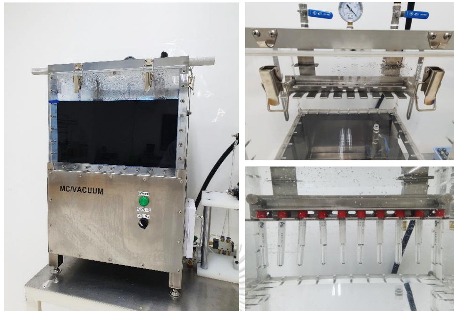
รูปที่ 3.9 เครื่องทดสอบรอยร้าวในระบบสุญญากาศสำหรับใช้ทดสอบการคืนตัวกลับหลังแทงเข็ม
