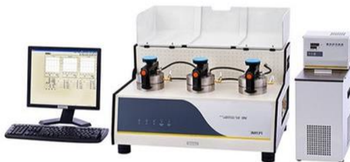
รูปที่ 3.11 เครื่องทดสอบวัดการซึมผ่านของแก๊ส รุ่น VAC-V2 [37]
