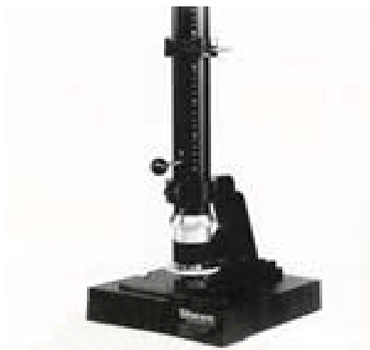
รูปที่ 3.12 เครื่องวัดความทนทานต่อแรงกระแทก
