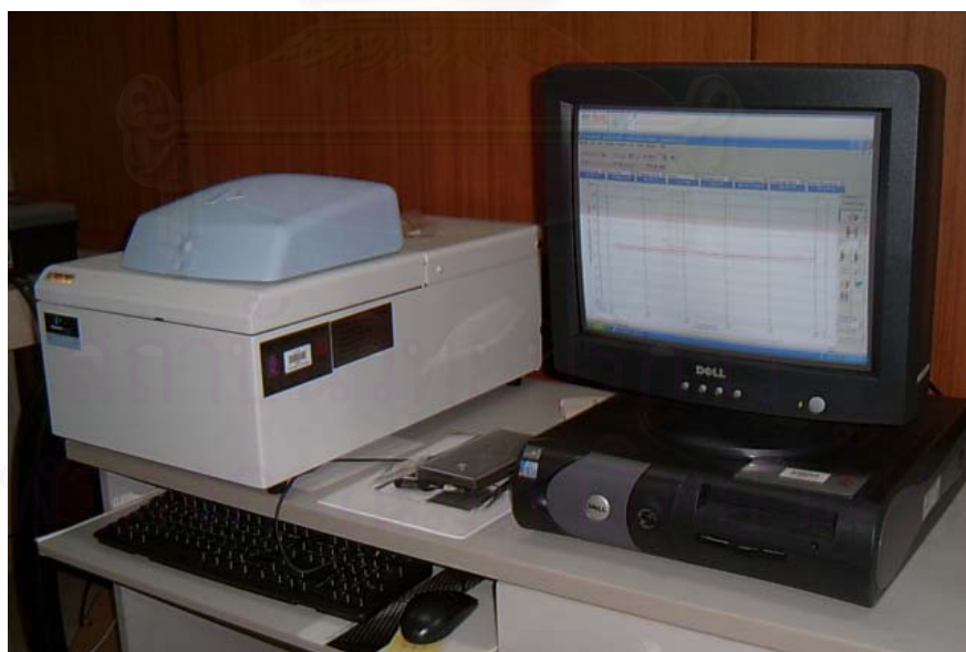
รูปที่ 3.6 ดีฟเฟอเรนเชียลสแกนนิ่งแคลอริมิเตอร์ ของ Perkin Elmer รุ่น Diamond DSC
