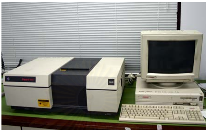
รูปที่ 3.1 ฟลูออโรสเปกโตรโฟโตมิเตอร์อินฟราเรดสเปกโทรโฟโตมิเตอร์ ของ Nicolet รุ่น Impact 400 D
