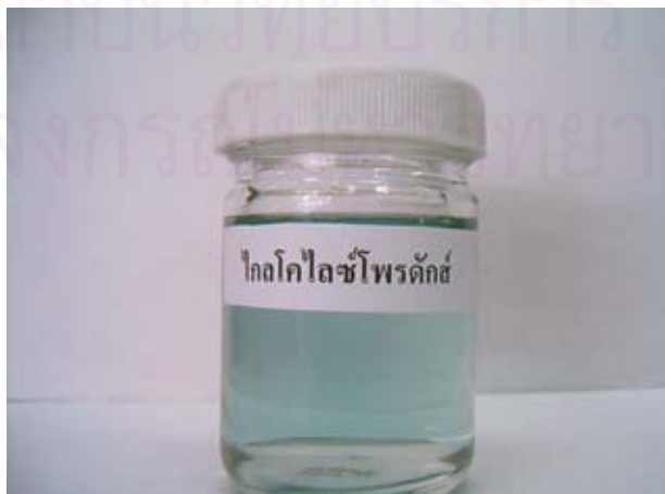
รูปที่ 4.2 ไกลโคไลซ์โพรดักส์ที่ได้จากการย่อยสลายขวดเพตด้วยวิธีไกลโคลิซิส
