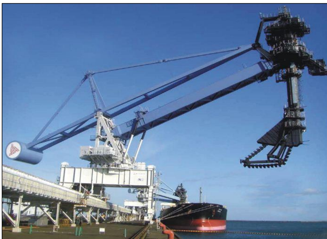
รูปที่ 1.5-4 อุปกรณ์ลำเลียงถ่านหินจากเรือบรรทุก
