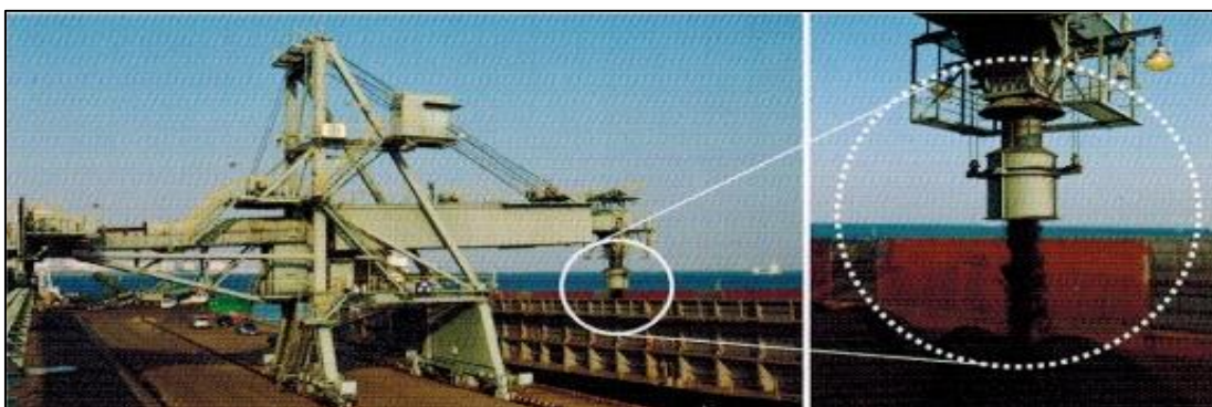
รูปที่ 3.3-6 เครื่องขนถ่ายถ่านหินลงเรือ (ที่มา : ศูนย์กระจายถ่านหินชุกประเทศญี่ปุ่น)
