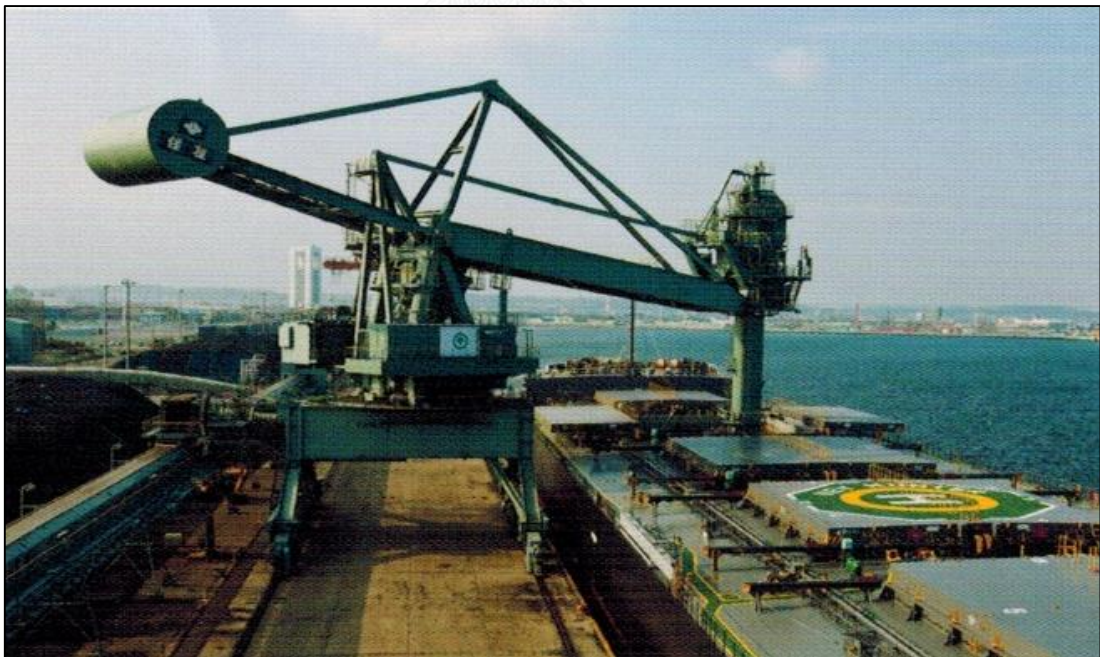
รูปที่ 1.5-6 เครื่องขนถ่ายถ่านหินลงเรือ
