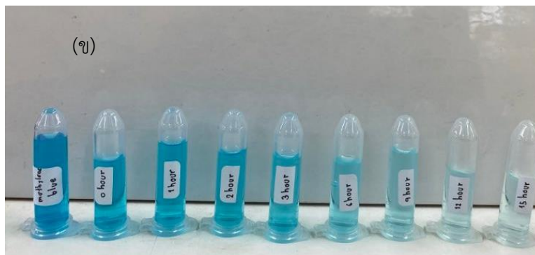
ภาพที่ 14 การเปลี่ยนแปลงทางกายภาพของสารละลายเมทิลีนบลูเมื่อผ่านกระบวนการการเร่งสลายด้วยแสงโดยใช้ตัวเร่งปฏิกิริยาแสงอนุภาคนาโน CZTS ที่สังเคราะห์ด้วยวิธี (ก) วิธีโซล-เจล (ข) วิธีไฮโดรเทอร์มอล
