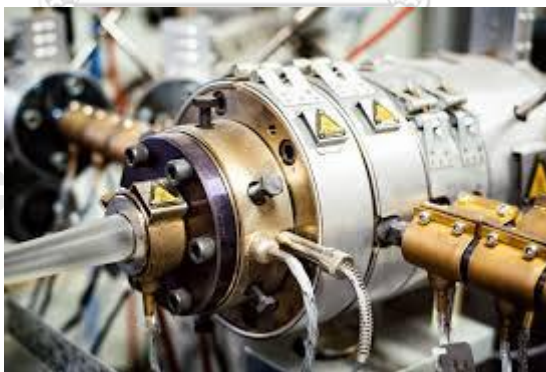
รูปที่ 26 แม่พิมพ์ที่ใช้สำหรับการอัดรีดท่อ 4
