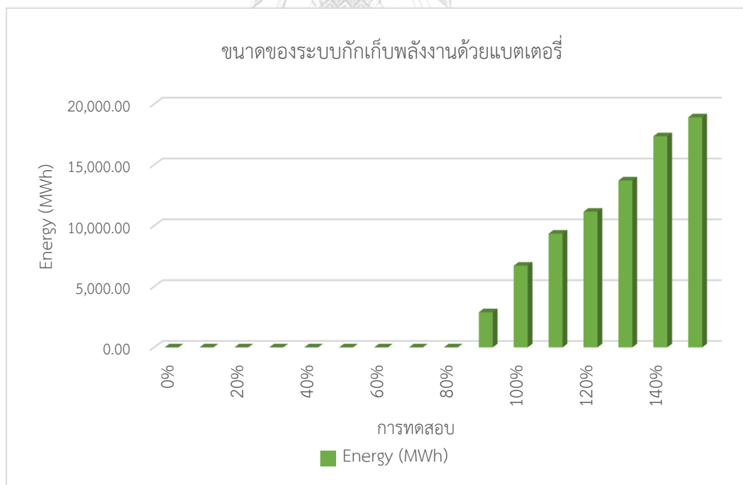
รูปที่ 6.19 ขนาดของระบบกักเก็บพลังงานด้วยแบตเตอรี่เมื่อกำหนดสถานะการรับและจ่ายประจุ
