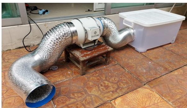
ภาพที่ 12 อุปกรณ์กำเนิดอนุภาคแบบประยุกต์
