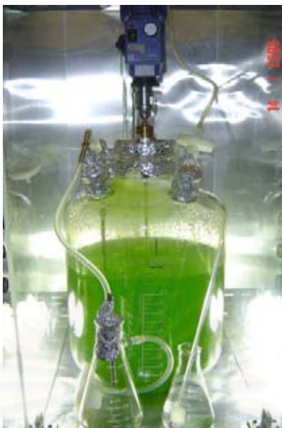
รูปที่ 3.5 ปฏิกรณ์ชีวภาพแสง พร้อมอุปกรณ์สำหรับกวนผสมและชุดเก็บตัวอย่างสาหร่าย
