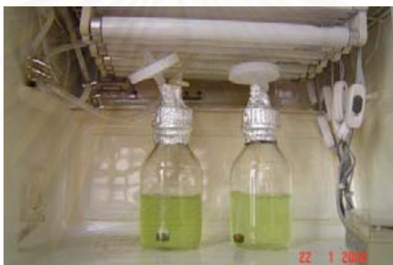
รูปที่ 3.6 ตู้ควบคุมอุณหภูมิ (Refrigerator thermostat) สำหรับเพาะเลี้ยงสาหร่ายตั้งต้น
