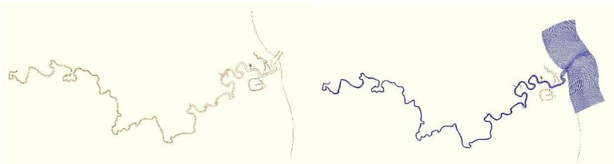
รูปที่ 3.4 แสดง grid ที่สร้างตามแนวชายฝั่งตลอดลำน้ำจากโปรแกรม Delft3D ที่ใช้ในการทำแบบจำลอง
