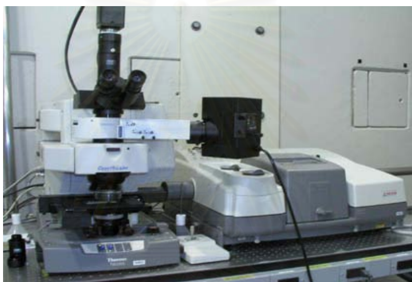
รูปที่ 3.10 เครื่องวิเคราะห์ทางสเปกโทรสโกปีด้วยรังสีอินฟราเรด (ATR-FTIR)
