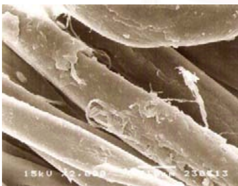
รูปที่ 4.52 แสดงพื้นผิวของผ้าฝ้ายที่เคลือบด้วยเฮกซะเดคซิลไตรเมทอกซีซิเลนร้อยละ 3 ของน้ำหนัก ปริมาณฟีนอลเท่ากับ 5 ด้วยกรดอะซิติก จากกล้อง SEM ที่กำลังขยาย 2,000 และ 10,000 เท่า
