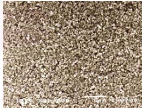
รูปที่ 4.49 แสดงพื้นผิวของอนุภาคซิลิกอนไดออกไซด์และอนุภาคซิลิกอนไดออกไซด์ในรูปแบบแขวนลอยร้อยละ 5 ของน้ำหนัก จากกล้อง SEM ที่กำลังขยาย 20,000 เท่า
