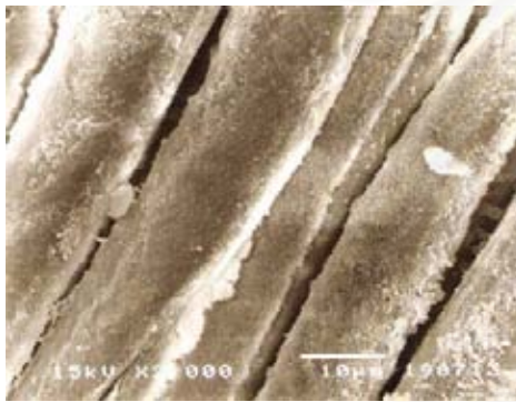
รูปที่ 4.51 แสดงพื้นผิวของผ้าฝ้ายที่ผ่านเคลือบด้วยชิตินคอนไดออกไซด์ร้อยละ 5 ของน้ำหนัก จากกล้อง SEM ที่กำลังขยาย 2,000 และ 10,000 เท่า
