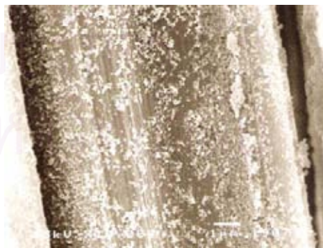
รูปที่ 4.55 แสดงพื้นผิวของผ้าไหมที่ผ่านเคลือบด้วยซิลิกอนไดออกไซด์ร้อยละ 5 ของน้ำหนัก จากกล้อง SEM ที่กำลังขยาย 2,000 และ 10,000 เท่า
