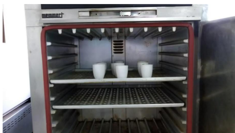
รูปที่ 1 อบตัวอย่างอาหารที่อุณหภูมิ 103-105 องศาเซลเซียสในตู้อบ (Hot air oven) เป็นเวลา 4 ชั่วโมง
