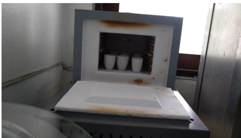
รูปที่ 2 เเผตัวอย่างอาหารที่อุณหภูมิ 550-600 องศาเซลเซียส นาน 4 ชั่วโมง
