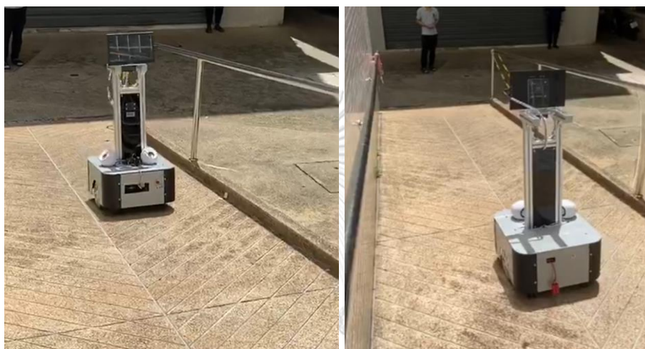
รูปที่ 32 หุ่นยนต์ขณะเคลื่อนที่ขึ้น (ซ้าย) และลง (ขวา) ทางชันประมาณ 9^\circ
