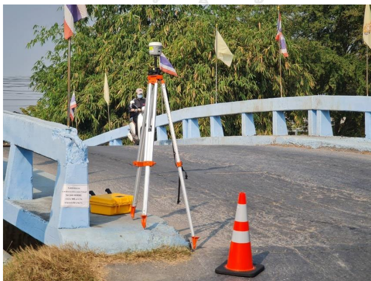
ภาพที่ 8 : การตั้งอุปกรณ์รับสัญญาณ GNSS แบบสถิตบนหมุดควบคุมทางดิ่ง
