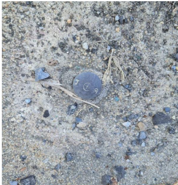
ภาพที่ 7 : หัวหมุดควบคุมทางดิ่งที่มีค่าความสูงออร์โทเมตริก (ระดับ)
