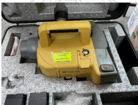
ภาพที่ 3 : กล้องระดับอิเล็กทรอนิกส์ ยี่ห้อ TOPCON รุ่น DL-501
