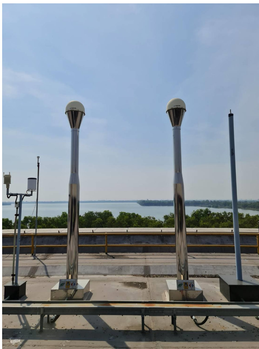
ภาพที่ 5 : สถานี CORS ของสถาบันมาตรวิทยาที่ใช้เป็นสถานีฐาน
