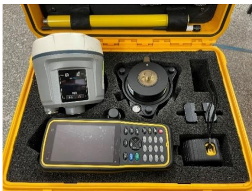
ภาพที่ 2 : เครื่องรับสัญญาณ GNSS ยี่ห้อ CHC รุ่น i80
