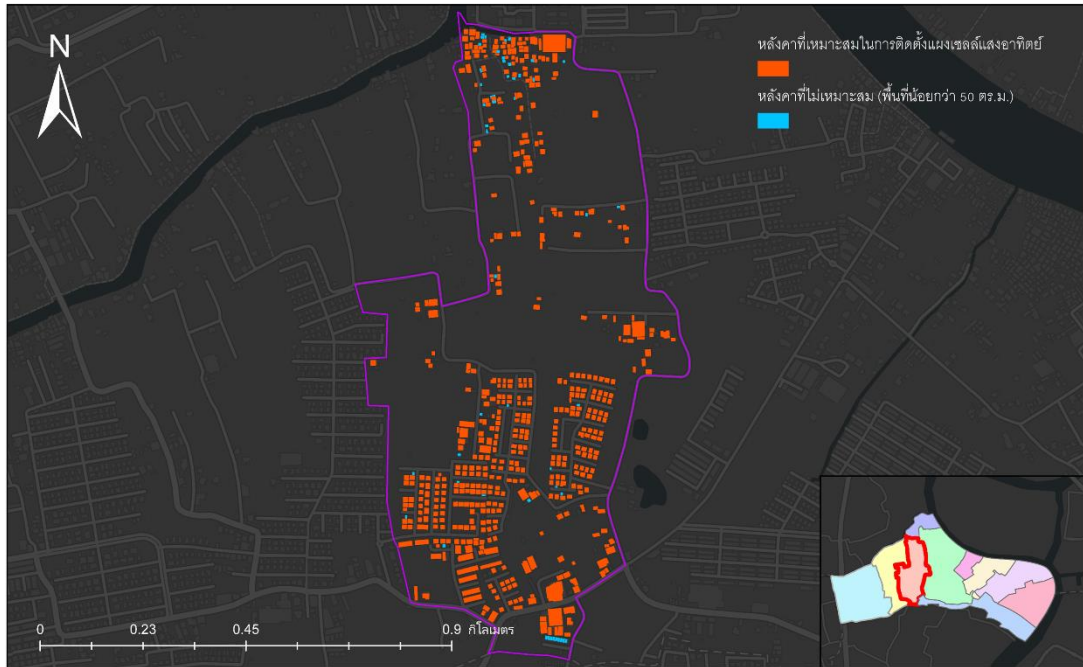
ภาพที่ ข.3 พื้นที่หลังคาที่เหมาะสมในการติดตั้งแผงเซลล์แสงอาทิตย์ หมู่ หมู่ 3 บ้านคลองขวาง
