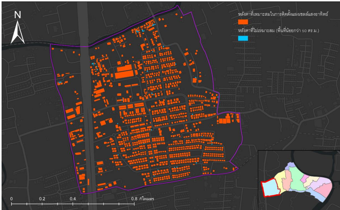
ภาพที่ ข.1 พื้นที่หลังคาที่เหมาะสมในการติดตั้งแผงเซลล์แสงอาทิตย์ หมู่ 1 บ้านคลองชมพู
