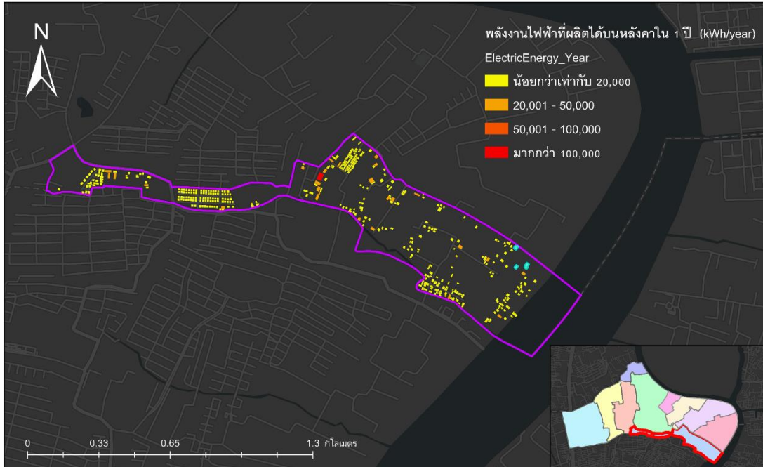
ภาพที่ ค.9 พลังงานไฟฟ้าที่ผลิตได้จากเซลล์แสงอาทิตย์บนหลังคาใน 1 ปี หมู่ 9 บ้านลำพูลาย
