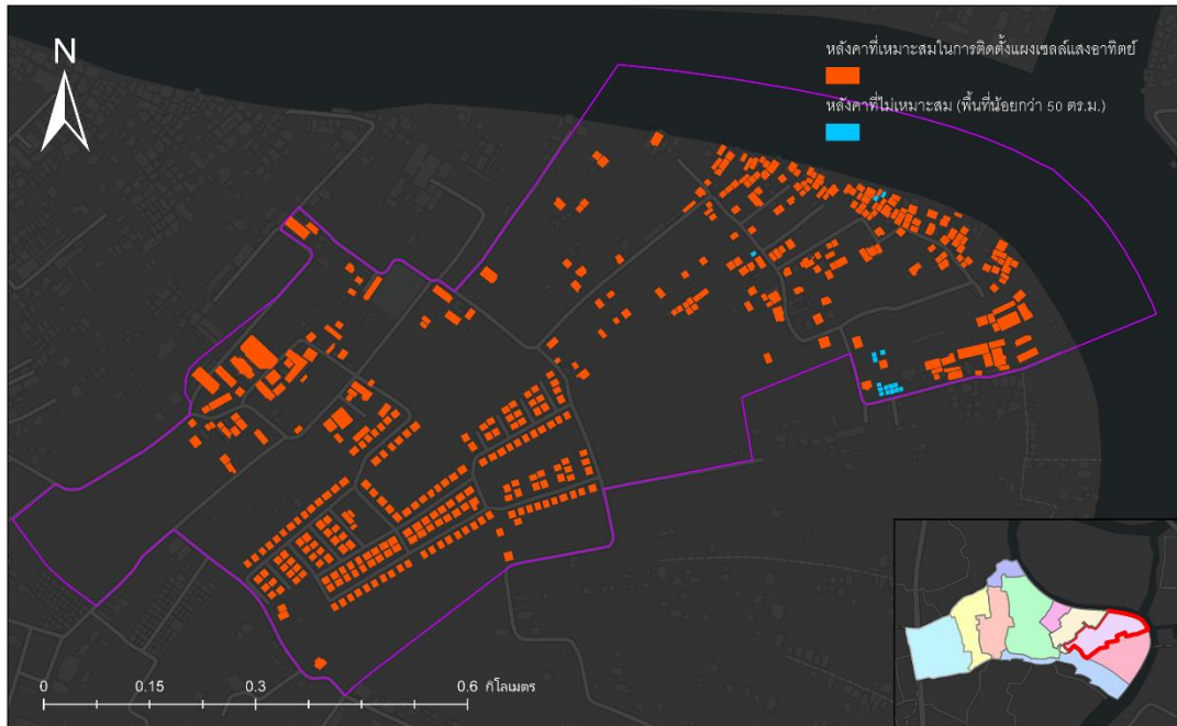
ภาพที่ ข.7 พื้นที่หลังคาที่เหมาะสมในการติดตั้งแผงเซลล์แสงอาทิตย์ หมู่ 7 บ้านสุหร้าแดง
