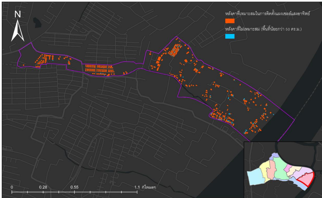
ภาพที่ ข.9 พื้นที่หลังคาที่เหมาะสมในการติดตั้งแผงเซลล์แสงอาทิตย์ หมู่ 9 บ้านลำพูลาย
