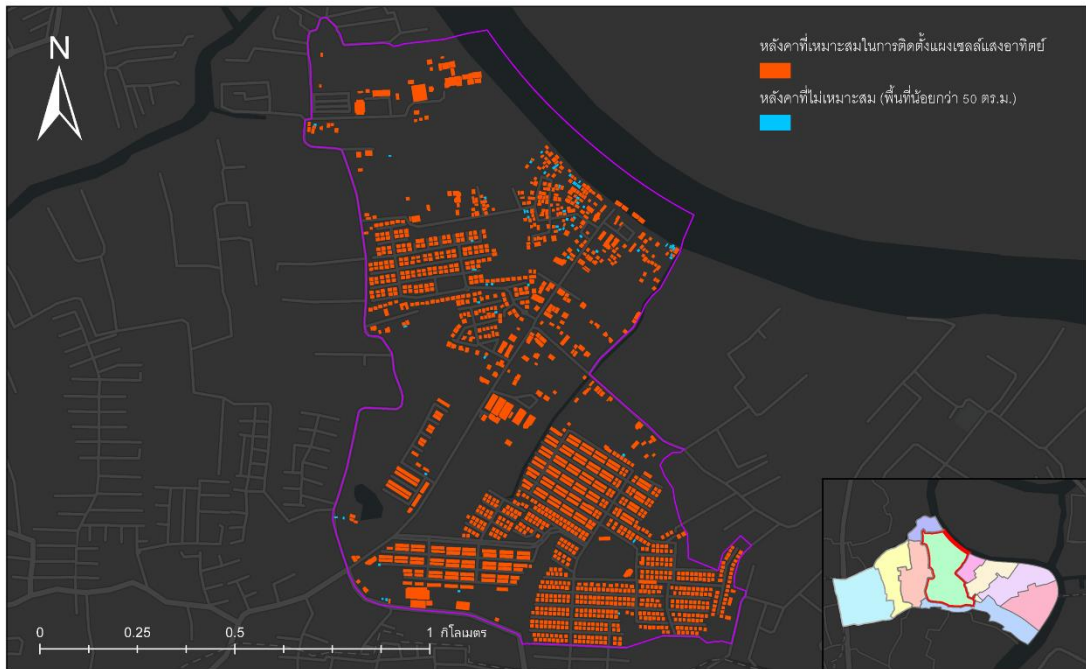
ภาพที่ ข.5 พื้นที่หลังคาที่เหมาะสมในการติดตั้งแผงเซลล์แสงอาทิตย์ หมู่ 5 บ้านลาดสิงห์
