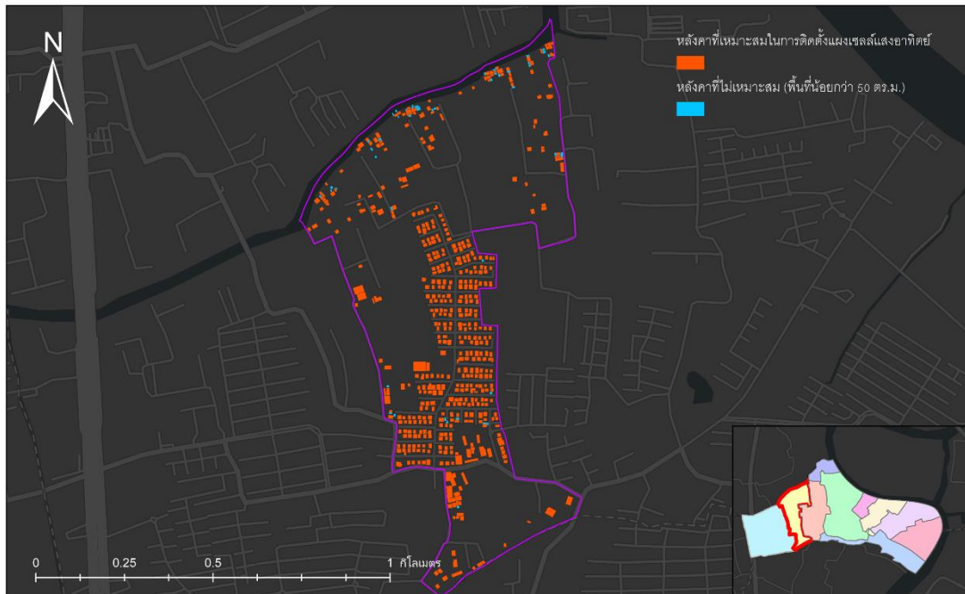
ภาพที่ ข.2 พื้นที่หลังคาที่เหมาะสมในการติดตั้งแผงเซลล์แสงอาทิตย์ หมู่ 2 บ้านคานเรือ
