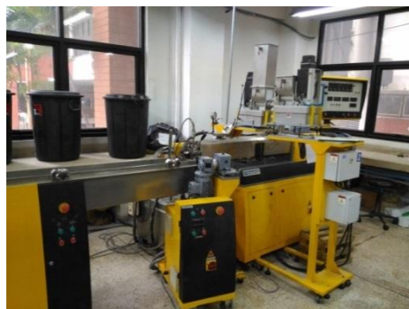
รูปที่ 3.4 เครื่องอัดรีดเกลียวคู่ที่ใช้ในการผสมพอลิเมอร์ระหว่างพอลิโพรพิลีนและแวกซ์
