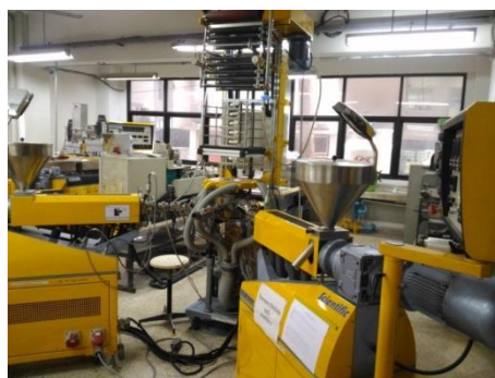
รูปที่ 3.5 เครื่องเป่าฟิล์มที่ใช้ในการขึ้นรูปเพื่อเตรียมฟิล์มรูปทรงแปดเหลี่ยม
