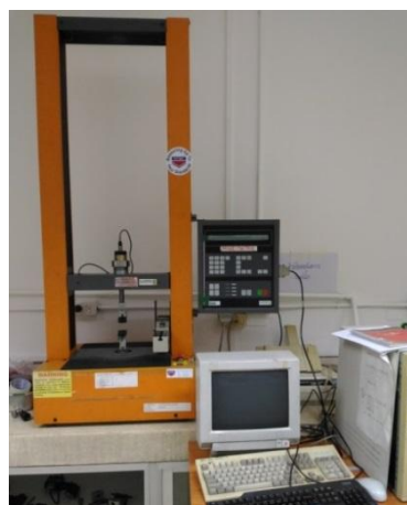
รูปที่ 3.6 เครื่อง Universal testing machine ของ LLOYD รุ่น LR100K(ก) และ LLOYD รุ่น 500(ข)
