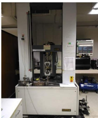
รูปที่ 3.6 เครื่อง Universal testing machine ของ LLOYD รุ่น LR100K(ก) และ LLOYD รุ่น 500(ข)
