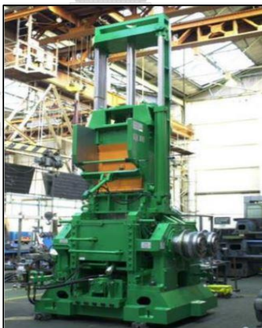
ภาพที่ 3 เครื่องผสมแบบบูรี (Banbury internal mixer)
