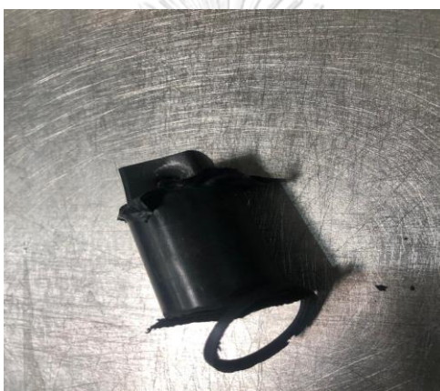
ภาพที่ 41 ภาพการฉีกขาดที่เกิดจากการทดลองของชิ้นงานรูปทรงซับซ้อน
