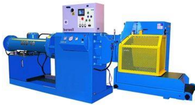
ภาพที่ 11 การขึ้นรูปโดยอัดผ่านหัวตาย (Extrusion)
