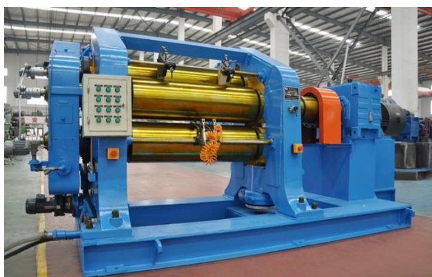
ภาพที่ 12 การขึ้นรูปโดยเครื่องคาลเอนเดอร์ (Calendering)
