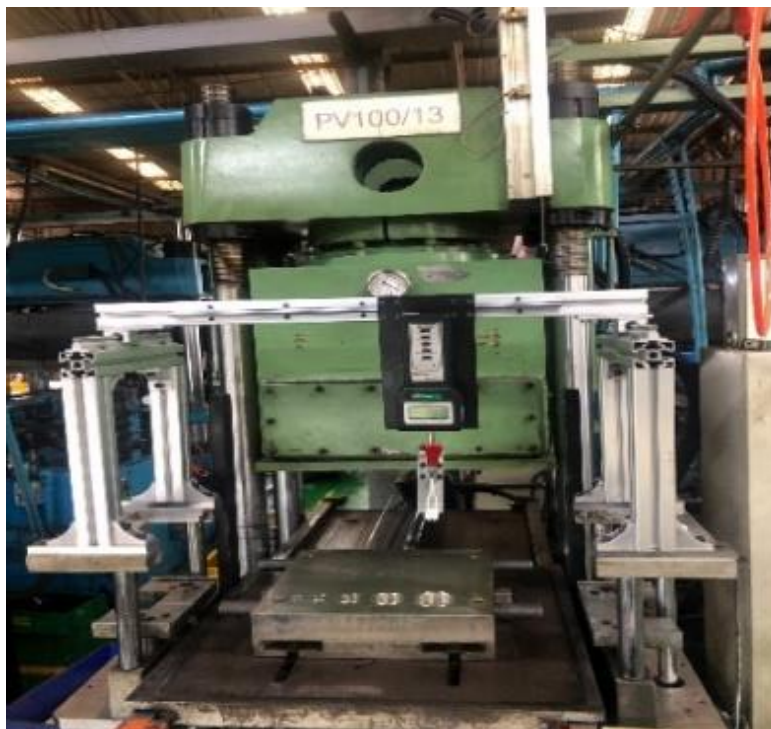
ภาพที่ 36 ภาพการทดลองวัดแรงปลดชิ้นงาน (Demolding force)
