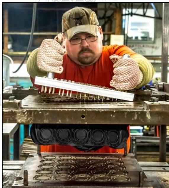
ภาพที่ 15 การใช้อุปกรณ์ช่วยในการนำชิ้นงานจากแม่พิมพ์
