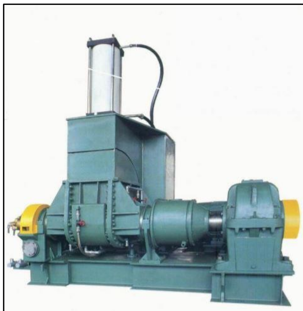
ภาพที่ 4 เครื่องนวดยางหรือนีดเดอร์ (Kneader)
