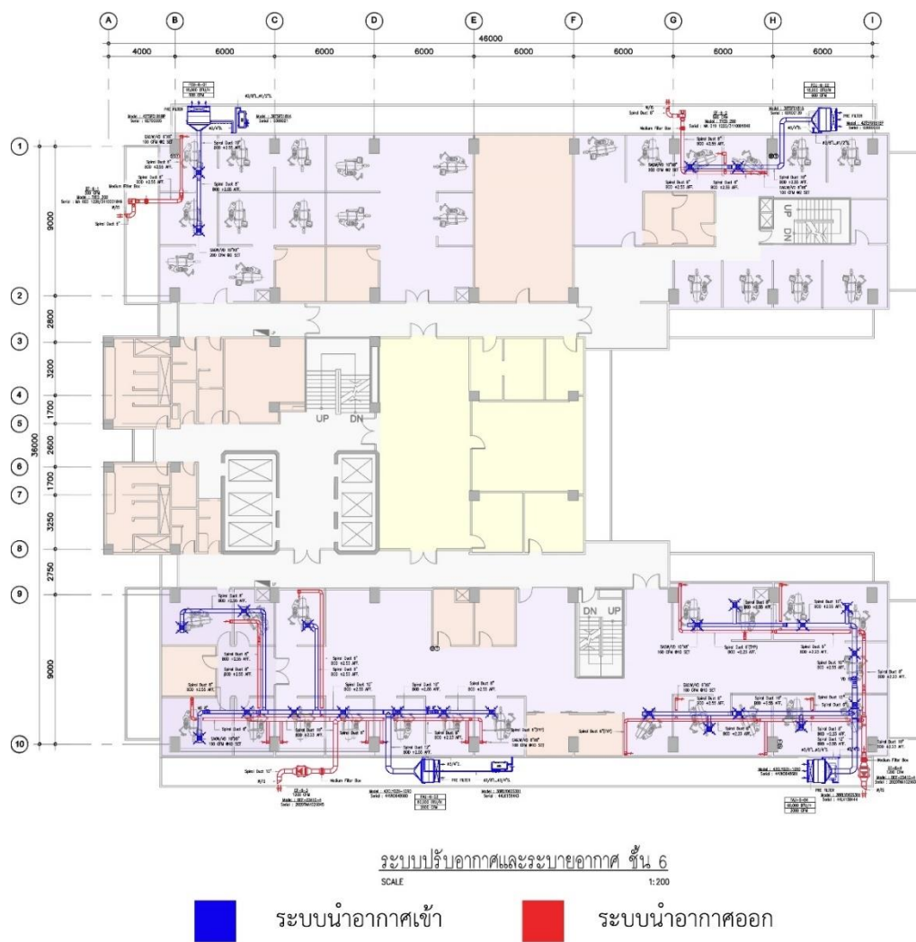
รูปที่ 24 แสดงงานระบบเติมและระบายอากาศของอาคาร A3 ชั้น 6
