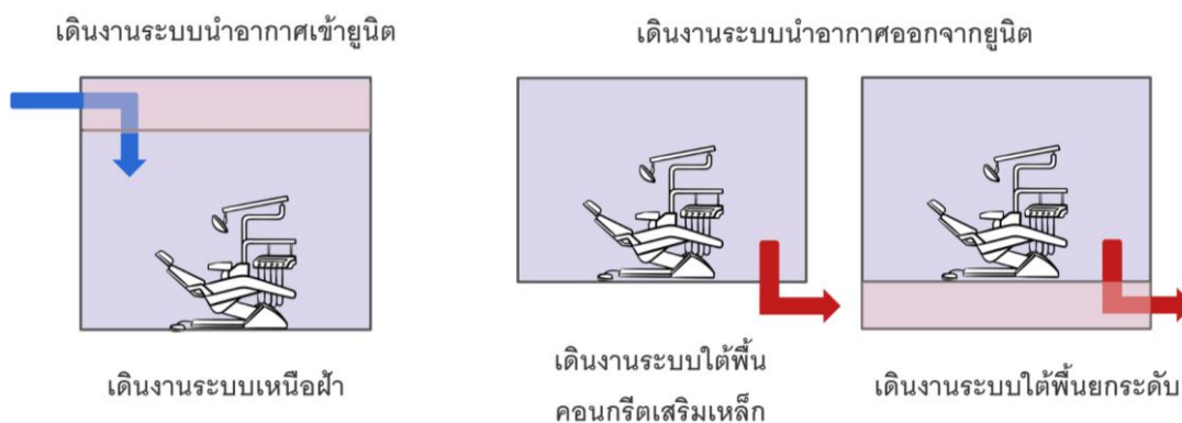
รูปที่ 70 วิธีการเดินงานระบบระบายหรือฟอกอากาศที่ยูนิตให้เรียบร้อย
