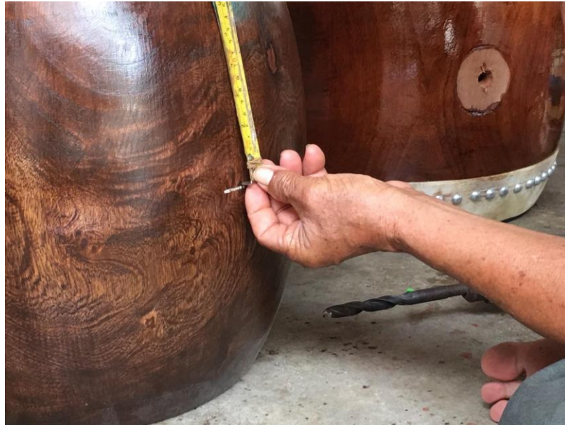
ภาพที่ 76 การวัดหาจุดศูนย์กลาง ที่มา: ประเมษฐ์ เอียดนิมิตร บันทึกเมื่อวันที่ 28 กรกฎาคม 2563
