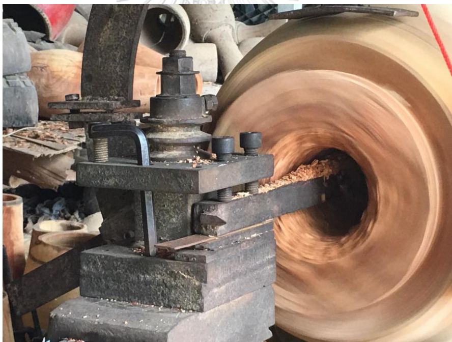
ภาพที่ 70 การคว้านหุ่นกลองตัด
