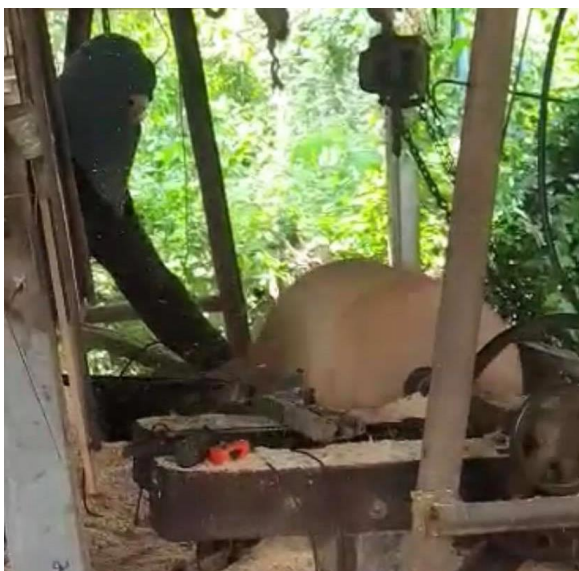
ภาพที่ 68 การกลึงหัวท้ายของท่อนกลองทัด ที่มา: ประเมษฐ์ เอียดนิมิตร บันทึกเมื่อวันที่ 20 มิถุนายน 2563
