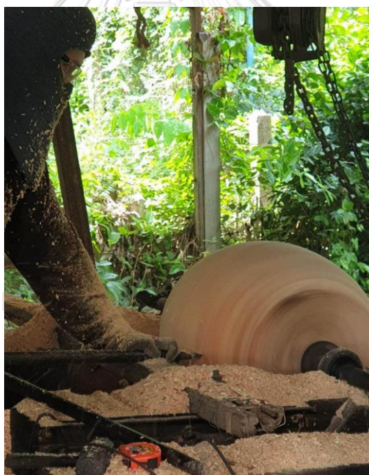
ภาพที่ 69 การกลึงไล่ระดับเพื่อทำกระพุ่มกลองทัด ที่มา: ประเมษฐ์ เอียดนิมิตร บันทึกเมื่อวันที่ 20 มิถุนายน 2563
