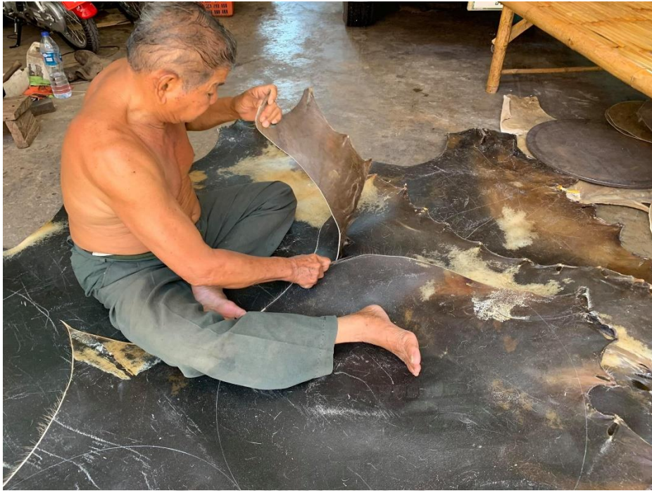
ภาพที่ 52 การตัดส่วนที่จะนำมาใช้สร้างกลองทัด ที่มา: ประเมษฐ์ เอียดนิมิตร บันทึกเมื่อวันที่ 19 พฤษภาคม 2563
