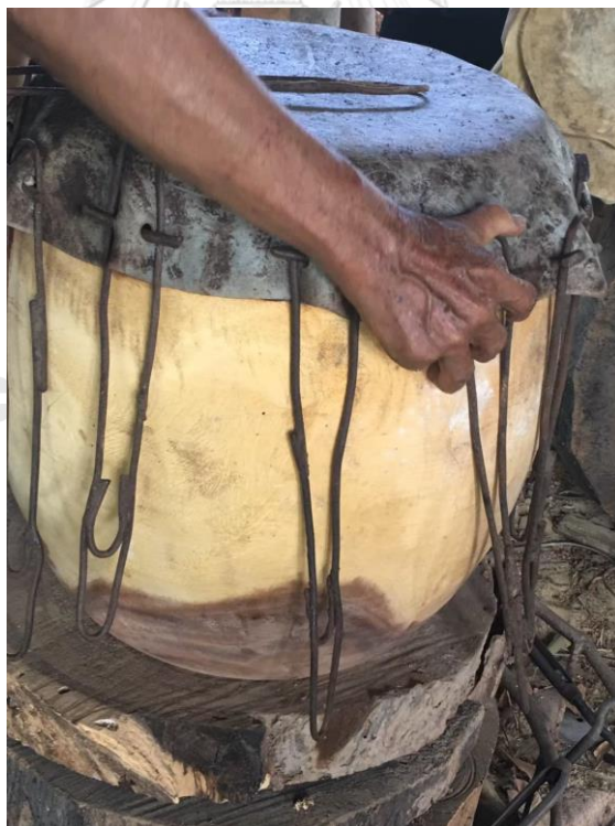
ภาพที่ 62 การใส่เหล็กเชื่อมระหว่างเหล็กสาแหรก และเหล็กเกลียว ที่มา: ประเมษฐ์ เอียดนิมิตร บันทึกเมื่อวันที่ 19 พฤษภาคม 2563
