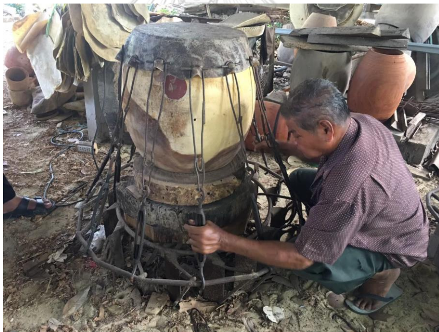
ภาพที่ 64 การหมุนเหล็กเกลียวเพื่อชิงหน้ ที่มา: ประเมษฐ์ เอียดนิมิตร บ้านทีกเมื่อวันที่ 19 พฤษภาคม 2563
