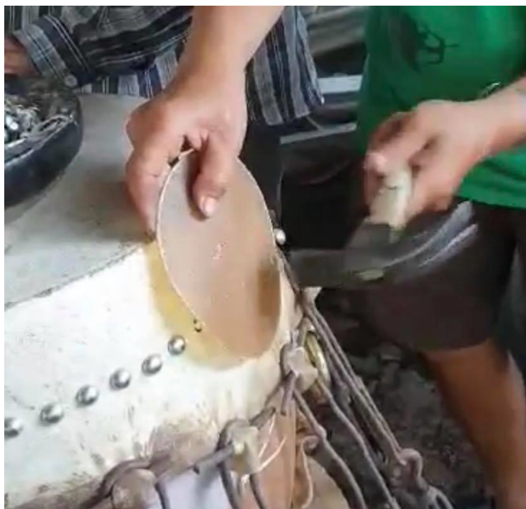
ภาพที่ 84 การตอกแล้โดยมีหนังรอง ที่มา: ประเมษฐ์ เอียดนิมิตร บันทึกเมื่อวันที่ 28 กรกฎาคม 2563
