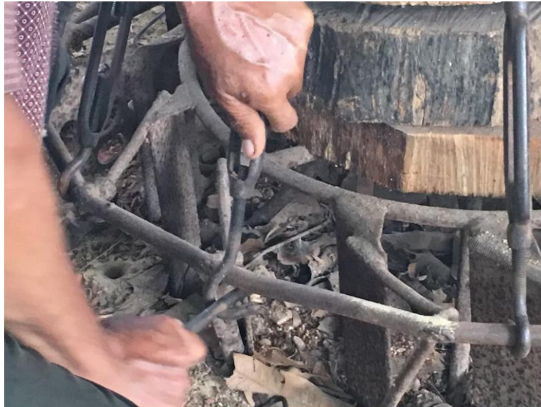
ภาพที่ 63 การใส่เหล็กเกลียวเข้ากับแป้นชิงหน้ ที่มา: ประเมษฐ์ เอียดนิมิตร บ้านทีกเมื่อวันที่ 19 พฤษภาคม 2563
