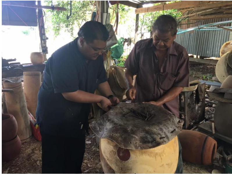
ภาพที่ 61 การใส่เหล็กสาแหรก ที่มา: ประเมษฐ์ เอียดนิมิตร บันทึกเมื่อวันที่ 19 พฤษภาคม 2563
