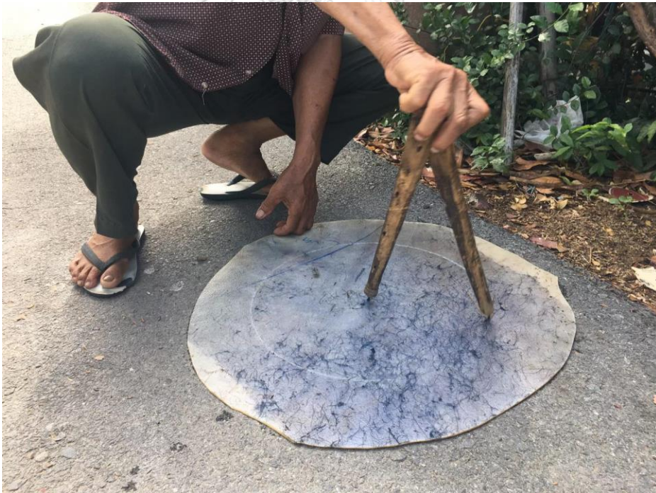
ภาพที่ 53 การตีวงเวียนภายในแผ่นหนังเพื่อนำไปใช้สำหรับขั้นตอนการนำหนังขึ้นแป้น ที่มา: ประเมษฐ์ เอียดนิมิตร บันทึกเมื่อวันที่ 19 พฤษภาคม 2563
