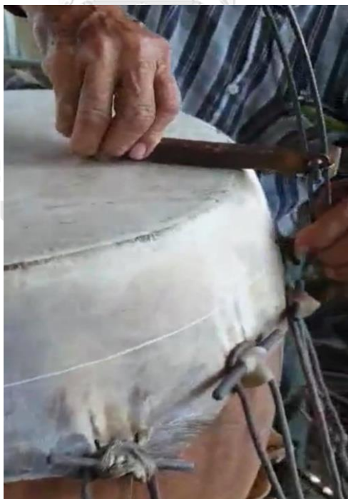
ภาพที่ 81 การติวงเวียนกำหนดจุดรูเส้น
