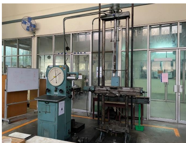
รูปที่ 18 เครื่องทดสอบแรงกดดัด AMSLER 20 TON
