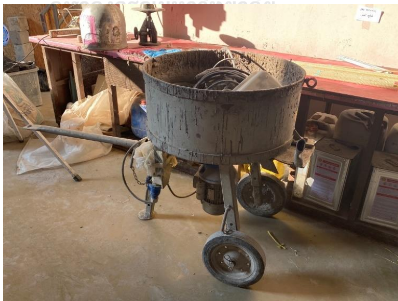
รูปที่ 17 เครื่องผสมคอนกรีตขนาดความจุ 50 ลิตร
