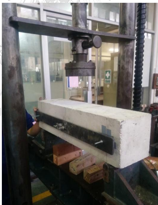
รูปที่ 19 ภาพการติดตั้งและการเตรียมทดสอบคานตัวอย่าง
