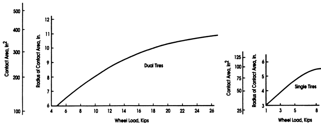
รูปที่ 7 ตัวอย่างขนาดน้ำหนักล้อต่อแรงกระทำของรถบรรทุก[10]
