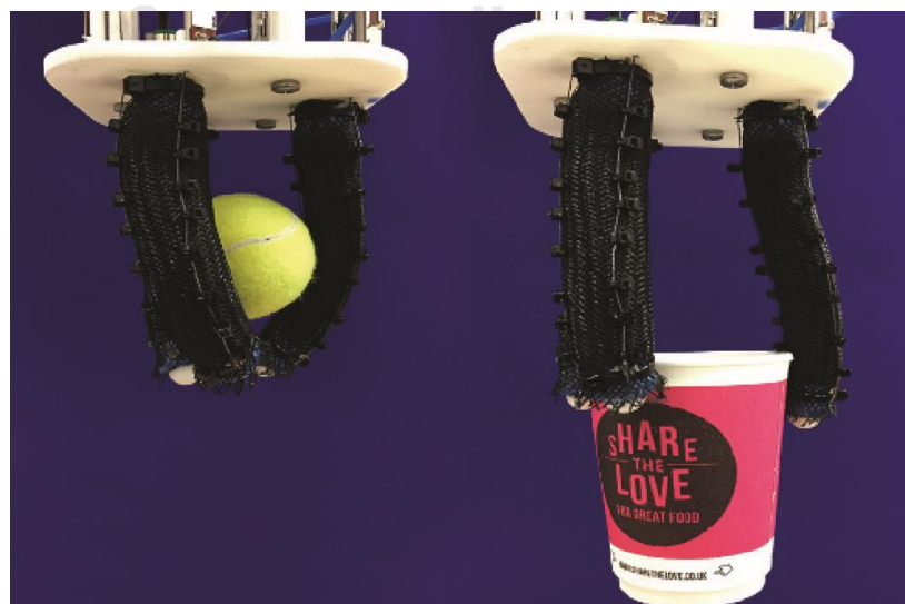
รูปที่ 2.15 แสดงนิ้วจับที่ขับเคลื่อนด้วยสายเคเบิลและปรับค่าความแข็งด้วยการบีบอัดอนุภาค
