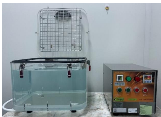
ภาพที่ 3.10 เครื่องตรวจการรั่วของแผงยา (Leak Tester) และแผงยาหลังจากผ่านการตรวจ
