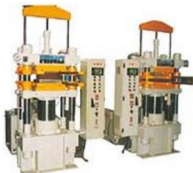
รูปที่ 2.22 เครื่องจักรแม่พิมพ์แบบกึ่งฉีด (transfer molding machine) (สถาบันพลาสติก, 2013)
