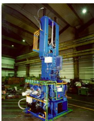
รูปที่ 2.18 เครื่องผสมยางระบบปิดแบบที่ปรับระยะห่างระหว่างโรเตอร์ได้ (variable intermeshing clearance internal mixer) (สถาบันพลาสติก, 2011)
