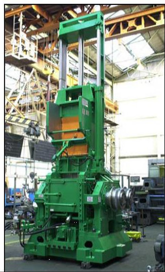
รูปที่ 2.16 เครื่องผสมระบบปิดแบบบุนูรี (banbury internal mixer) (สถาบันพลาสติก, 2011)
