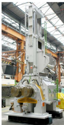
รูปที่ 2.17 เครื่องผสมยางระบบปิดแบบอินเตอร์มิกซ์ (intermix internal mixer) (สถาบันพลาสติก, 2011)
