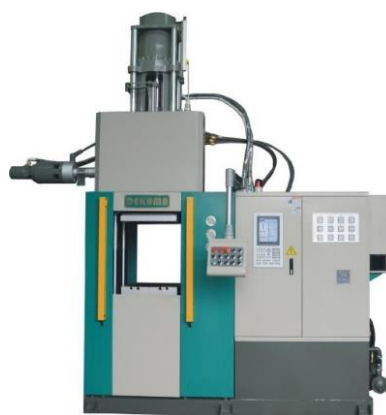
รูปที่ 2.23 เครื่องจักรแม่พิมพ์แบบฉีด (injection molding machine) (สถาบันพลาสติก, 2013)
