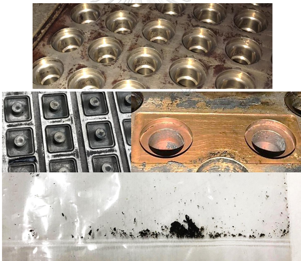
รูปที่ 4.1 ลักษณะคราบที่เกิดขึ้นบนแม่พิมพ์
