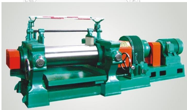
รูปที่ 2.15 เครื่องผสมยางแบบสองลูกกลิ้ง (two-roll mill) (สถาบันพลาสติก, 2011)
