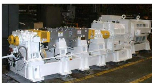
รูปที่ 2.20 เครื่องผสมยางแบบต่อเนื่อง (continuous mixer) (สถาบันพลาสติก, 2011)
