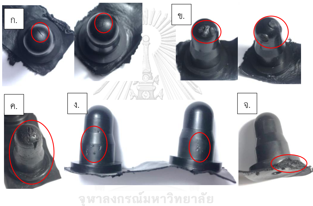
รูปที่ 4.14 ลักษณะของเสียที่เกิดขึ้นในชิ้นงาน ก) แผล, ข) พอง, ค) ยางไม่เต็ม, ง) คราบ และ จ) ฉีกขาด
