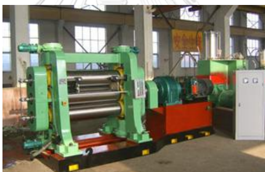
รูปที่ 2.25 เครื่องคาลเ็นเดอร์ (calender) (สถาบันพลาสติก, 2013)
