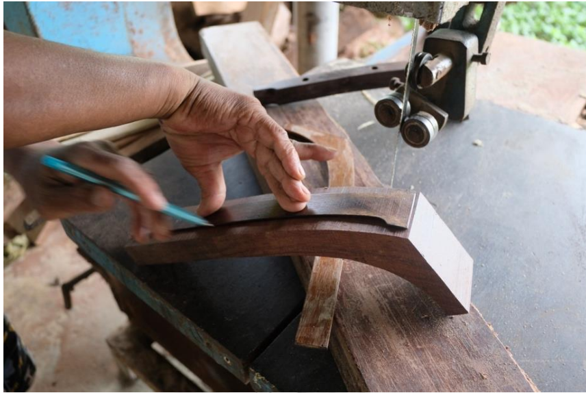
ภาพที่ 115 การนำต้นแบบมาวัดอีกด้านของโขนซอ ที่มา: ศศิตรา ธรรมรัตน์
