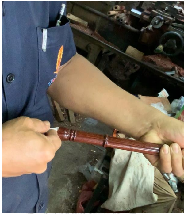
ภาพที่ 250 การคว้านหรือเหลาเท้าเหยียบเพื่อสามารถสวมกับกระบอกซอด้วง ที่มา: ศลิตรา ธรรมรัตน์
