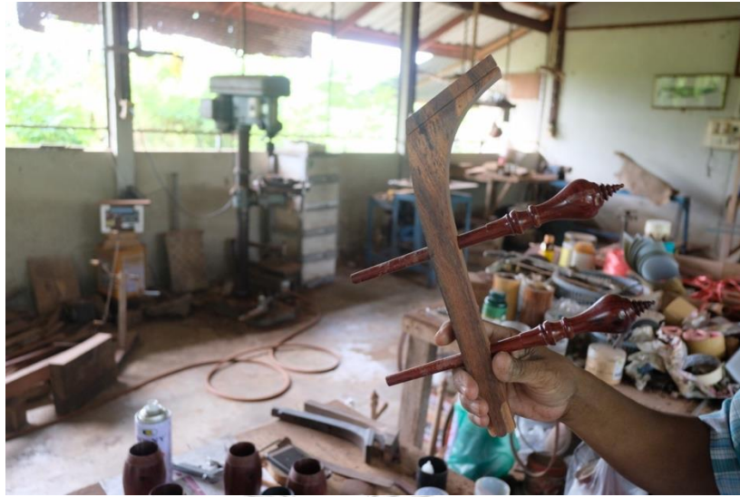
ภาพที่ 135 การนำโขนซอมาใส่ลูกบิดต้นแบบเพื่อวัดขนาดที่ต้องการ ที่มา: ศศิตรา ธรรมรัตน์
