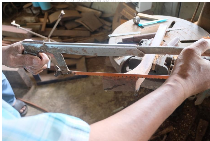
ภาพที่ 120 การนำเลื่อยบากเป็นเส้นตรง ที่มา: ศลิตรา ธรรมรัตน์
