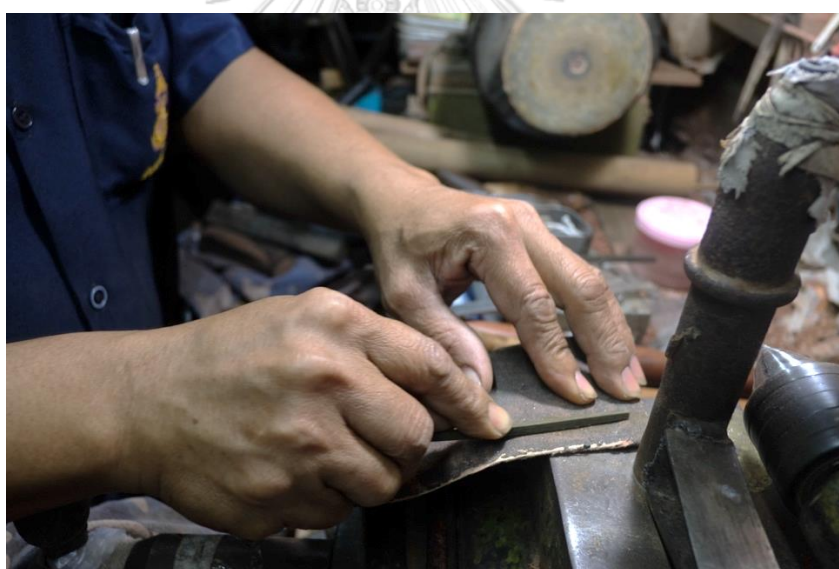
ภาพที่ 242 การขัดเหลาตกแต่งรูปทรงด้วยกระดาษทราย ที่มา: ศศิตรา ธรรมรัตน์
