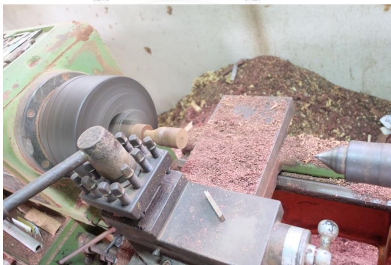
ภาพที่ 151 การนำลูกบิดเข้าเครื่องกลึง ที่มา: ศลิตรา ธรรมรัตน์
