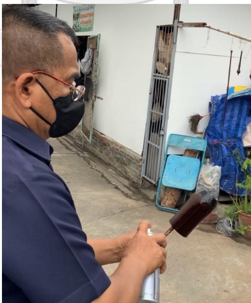
ภาพที่ 228 การพ่นแลคเกอร์กระบะบอกซอ
