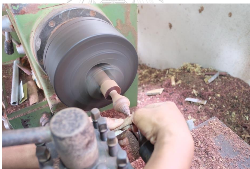
ภาพที่ 155 การนำกระดาษทรายขัดในส่วนปลายของลูกบิด ที่มา: ศศิตรา ธรรมรัตน์
