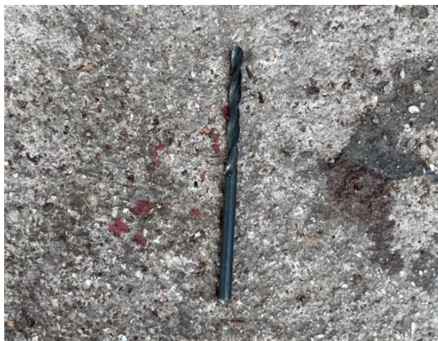
ภาพที่ 70 ดอกสว่านสำหรับเจาะคันทวนใส่ลูกบิด ที่มา: ศลิตรา ธรรมรัตน์
