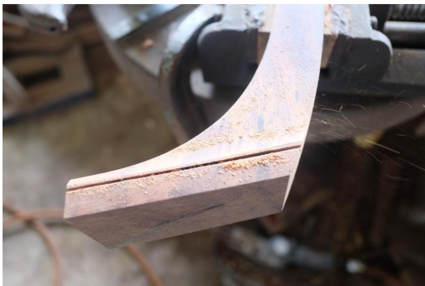
ภาพที่ 121 ด้านบนของโขนซอเมื่อทำการเป็นปากเส้นตรงเรียบร้อยแล้ว ที่มา: ศศิตรา ธรรมรัตน์
