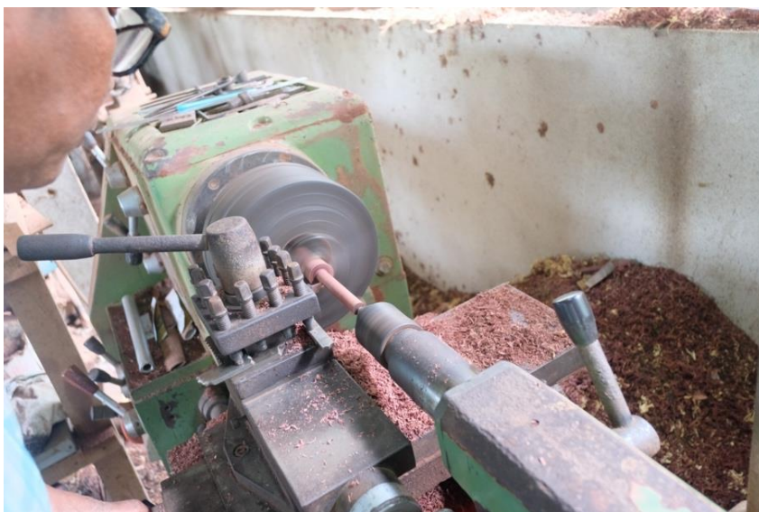
ภาพที่ 143 การนำชิ้นงานเข้าเครื่องเพื่อกลึงคันทวนในส่วนปลายที่ได้ทำการวัดไว้ ที่มา: ศศิตรา ธรรมรัตน์
