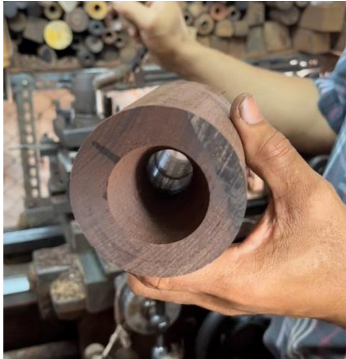
ภาพที่ 187 การกลึงด้านในฝั่งที่ใช้สำหรับขึ้นหนัง ที่มา: ศศิตรา ธรรมรัตน์
