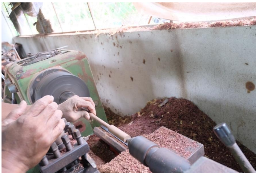
ภาพที่ 164 การเริ่มกลึงส่วนปลายคันทันชัก ที่มา: ศศิตรา ธรรมรัตน์
