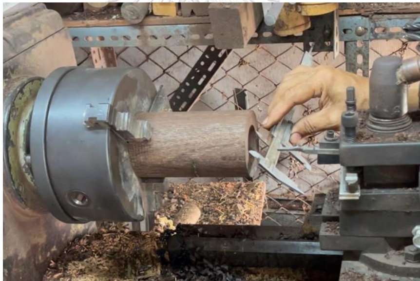
ภาพที่ 186 การวัดขนาดและกลึงด้านที่ใช้สำหรับขึ้นหนัง
