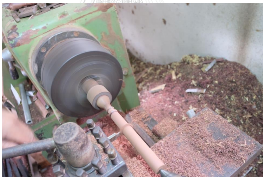
ภาพที่ 158 การกลึงตกแต่งบัวในส่วนของลูกบิด ที่มา: ศศิตรา ธรรมรัตน์
