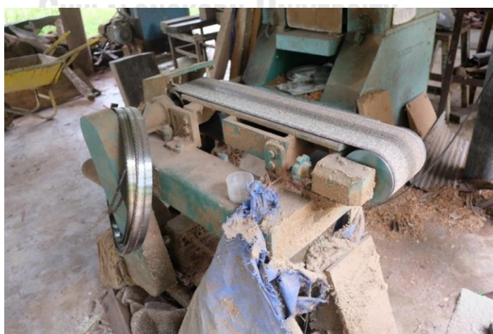
ภาพที่ 65 เครื่องขัดกระดาษทรายแนวอนแบบสายพาน
