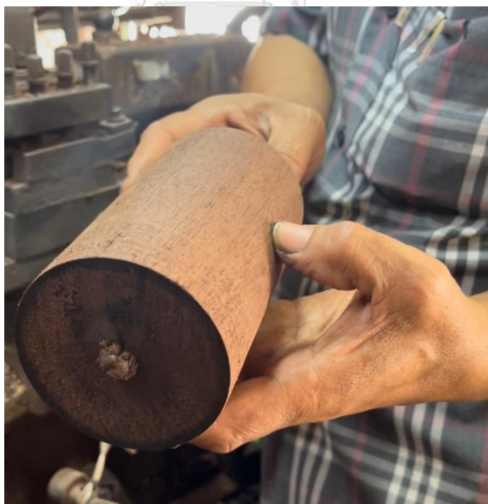
ภาพที่ 183 ไม้ในส่วนที่ใช้ทำกระบอกลึง ที่มา: ศศิตรา ธรรมรัตน์
