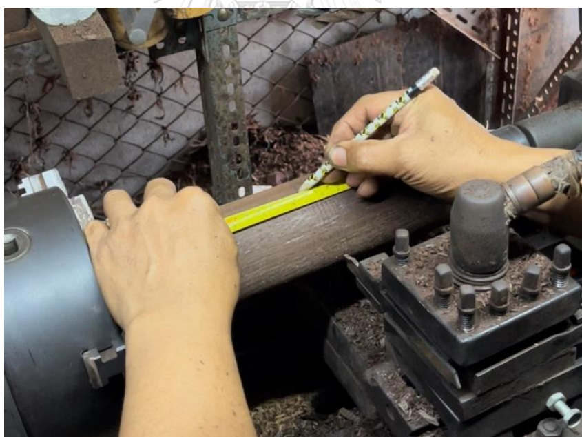
ภาพที่ 181 การวัดและขีดจุดที่ต้องการตัดชิ้นไม้ ที่มา: ศลิตรา ธรรมรัตน์
