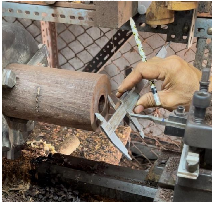
ภาพที่ 188 การวัดขนาดและกลึงด้านหน้ากระบอกขอ ที่มา: ศศิตรา ธรรมรัตน์
