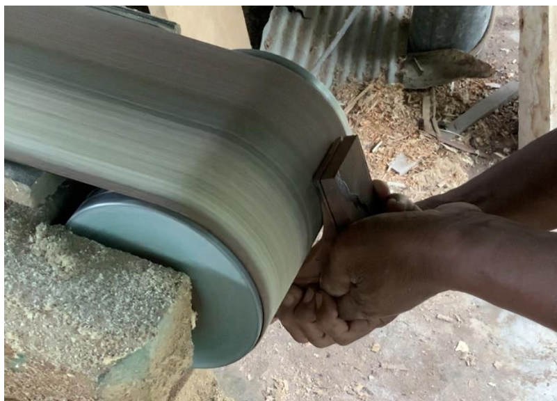
ภาพที่ 125 การนำด้านโค้งมนของโขนชอมาขัดกับเครื่องขัดกระดาษทราย ที่มา: ศศิตรา ธรรมรัตน์
