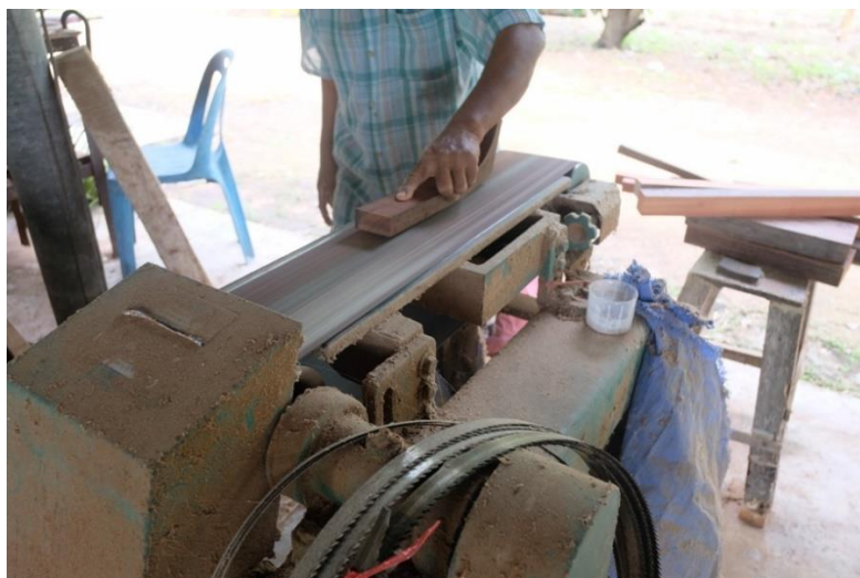
ภาพที่ 113 การนำไม้ขึ้นขัดบนเครื่องขัดกระดาษทราย ที่มา: ศลิตรา ธรรมรัตน์
