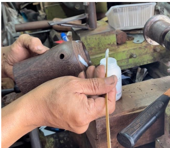
ภาพที่ 213 การทากาวลาเท็กซ์ ที่มา: ศลิตรา ธรรมรัตน์
