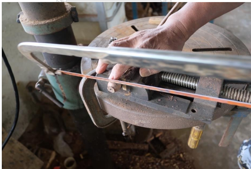
ภาพที่ 172 การเลื่อยเพื่อกำหนดจุดที่ต้องการคว้าน ที่มา: ศศิตรา ธรรมรัตน์
