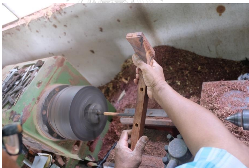
ภาพที่ 134 การนำชิ้นซอที่เจาะรูแล้วมาขัดด้านในเพื่อให้เรียบเนียน ที่มา: ศศิตรา ธรรมรัตน์
