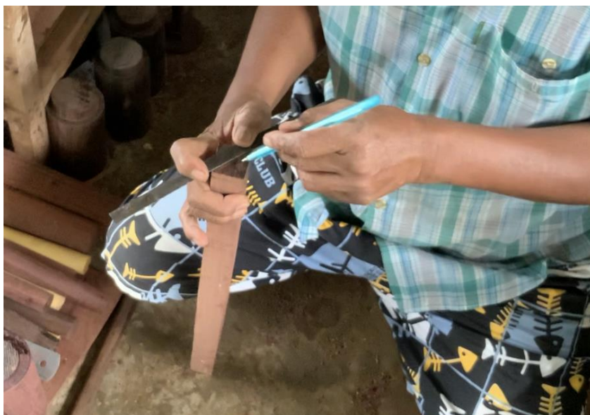
ภาพที่ 137 การนำปากกาขีดเส้นเพื่อหาจุดศูนย์กลาง ที่มา: ศศิตรา ธรรมรัตน์
