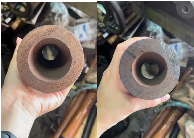
ภาพที่ 192 ครอบข้อดุ้งที่กลึงด้านในแล้วทั้งสองด้าน
