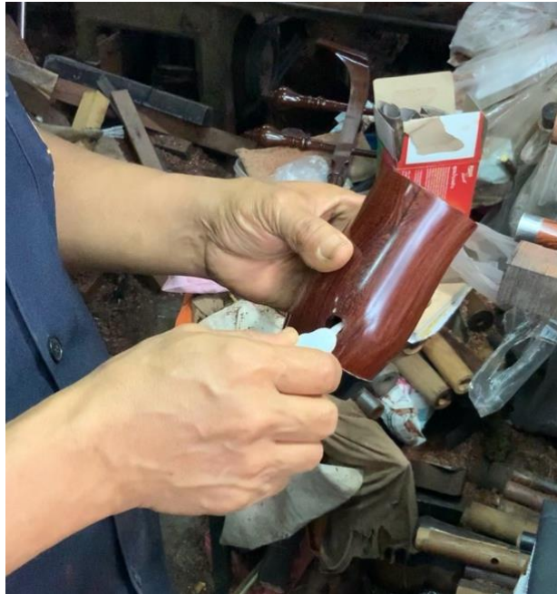
ภาพที่ 252 การตากความร้อนเพื่อให้กระบอกขยิดกับคันทวน ที่มา: ศลิตรา ธรรมรัตน์
