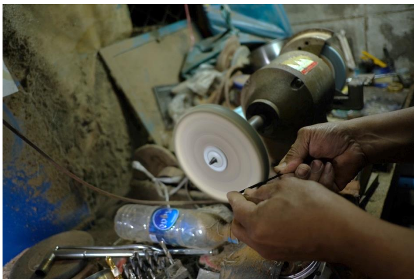
ภาพที่ 245 การตกแต่งเก็บรายละเอียดในขั้นตอนสุดท้ายด้วยเครื่องขัดเงา ที่มา: ศลิตรา ธรรมรัตน์
