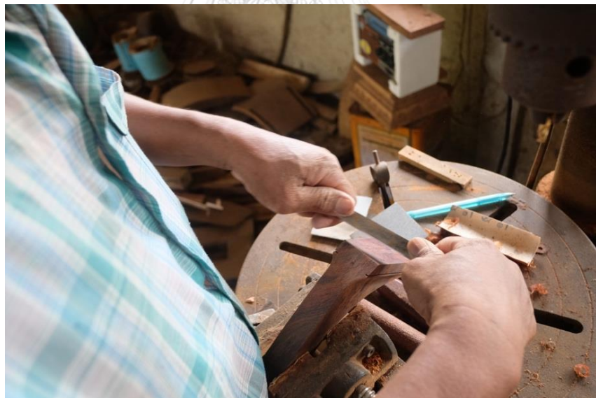
ภาพที่ 124 การนำใบมีดชุดไม้ด้านบนโซนซอให้เกิดความเรียบเนียน ที่มา: ศศิตรา ธรรมรัตน์
