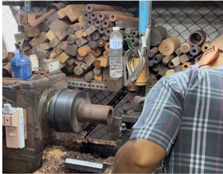
ภาพที่ 190 การกลึงด้านในกระบอกซอ ที่มา: ศศิตรา ธรรมรัตน์
