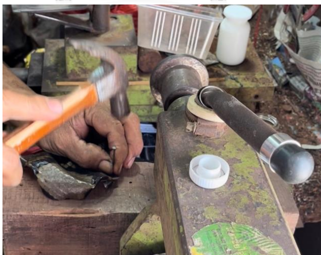
ภาพที่ 211 การนำตะปูมากลัดยึดกับหนังงู
