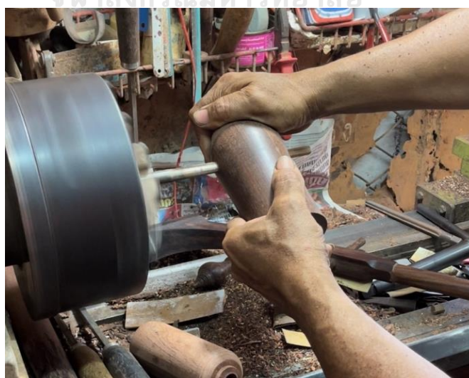
ภาพที่ 204 การนำริมเมอร์ขัดเพื่อลบคมและให้ได้ขนาดที่ต้องการ ที่มา: ศลิตรา ธรรมรัตน์
