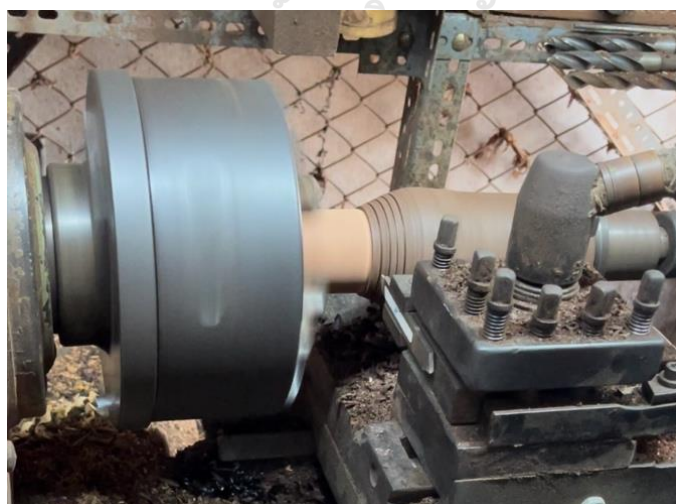
ภาพที่ 200 การกลึงปากกระบอกลูกสูบสำหรับด้านขึ้นผนัง
