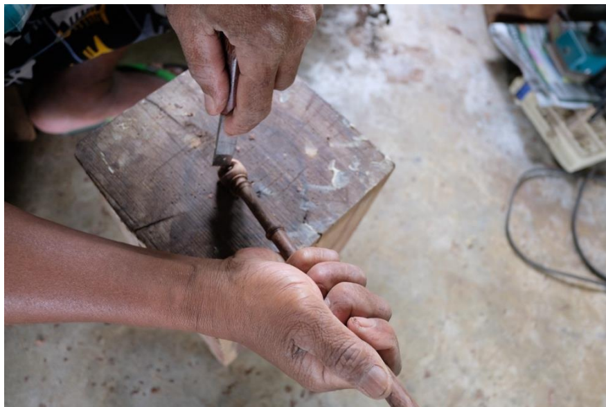
ภาพที่ 173 การนำส่วเหล็กมาบากคว้าน ที่มา: ศศิตรา ธรรมรัตน์
