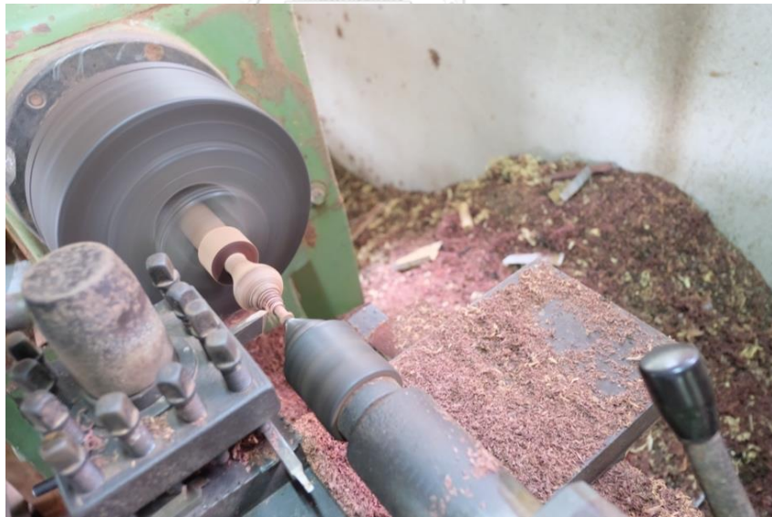
ภาพที่ 153 การกลึงลูกบิดส่วนบั่วของลูกบิด ที่มา: ศลิตรา ธรรมรัตน์
