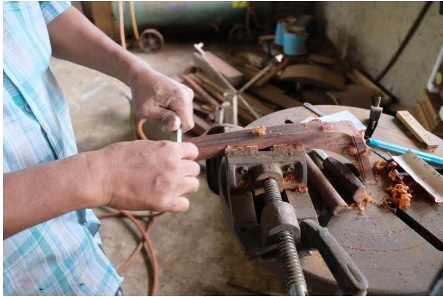
ภาพที่ 123 การนำใบมีดชุดเพื่อให้เกิดความเรียบเนียน ที่มา: ศศิตรา ธรรมรัตน์
