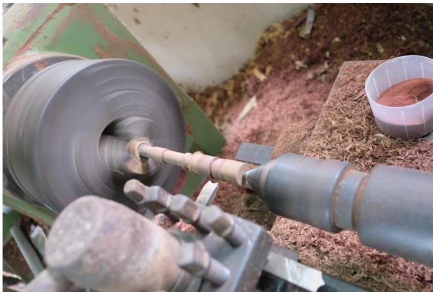
ภาพที่ 168 การกลึงส่วนของลูกแก้ว ที่มา: ศศิตรา ธรรมรัตน์
