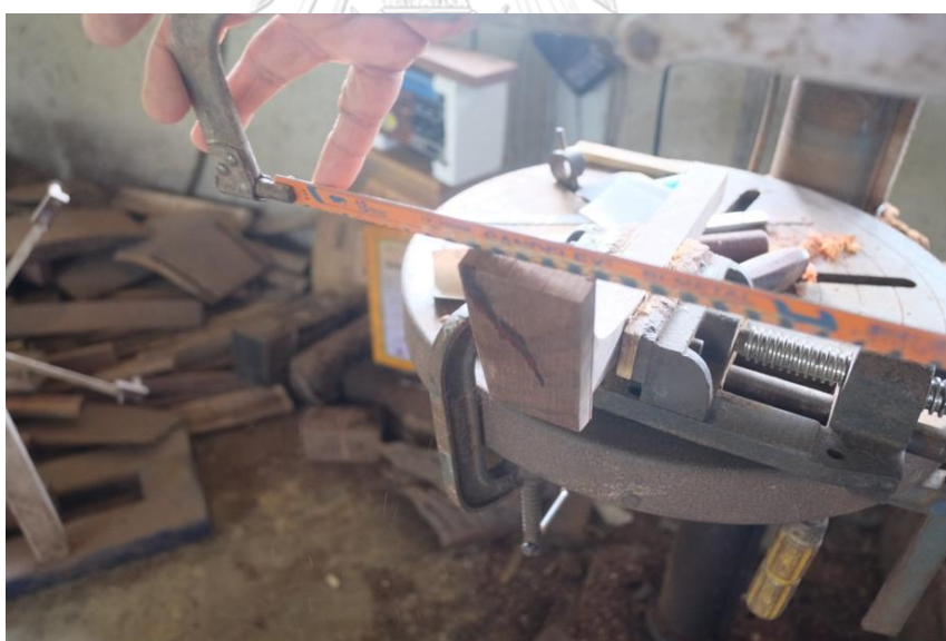
ภาพที่ 122 การนำเลื่อยบากอีกมุมหนึ่งของโขนซอ ที่มา: ศศิตรา ธรรมรัตน์
