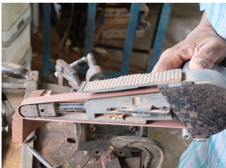
ภาพที่ 66 เครื่องขัดกระดาษทราย (เครื่องขัดลม)
