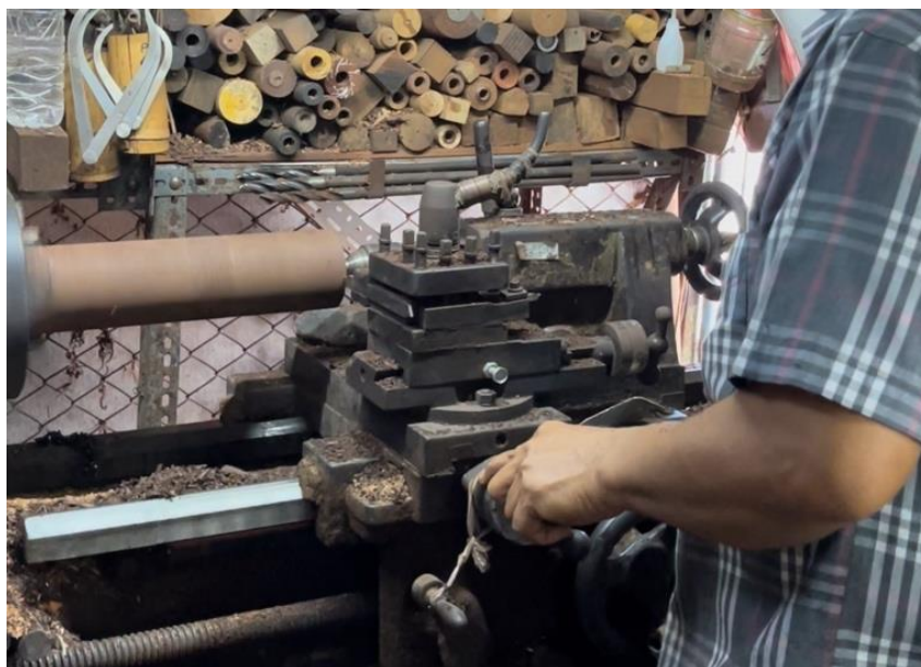
ภาพที่ 180 การนำท่อนไม้ขึ้นเครื่องกลึงเพื่อกลึงทั้งชิ้น ที่มา: ศลิตรา ธรรมรัตน์
