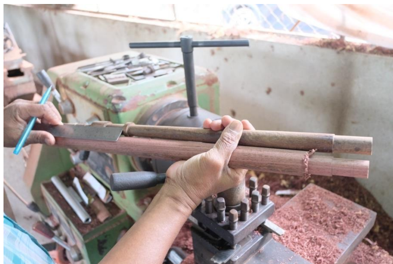
ภาพที่ 141 การนำคันทวนวัดกับส่วนปลายของคันทวนต้นแบบ ที่มา: ศศิตรา ธรรมรัตน์
