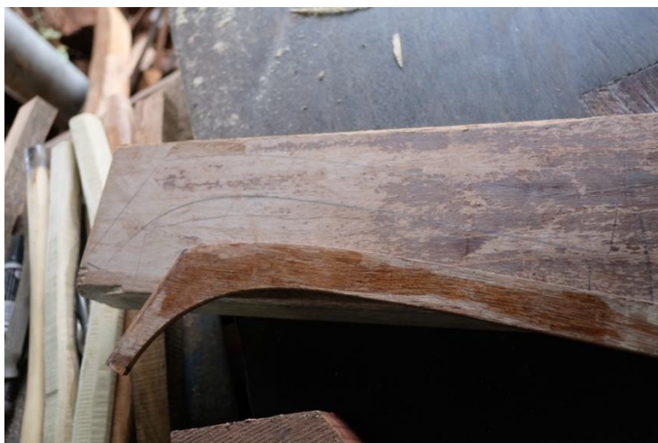
ภาพที่ 111 การนำไม้ที่คัดเลือกมาเขียนตามต้นแบบโขนซอ
