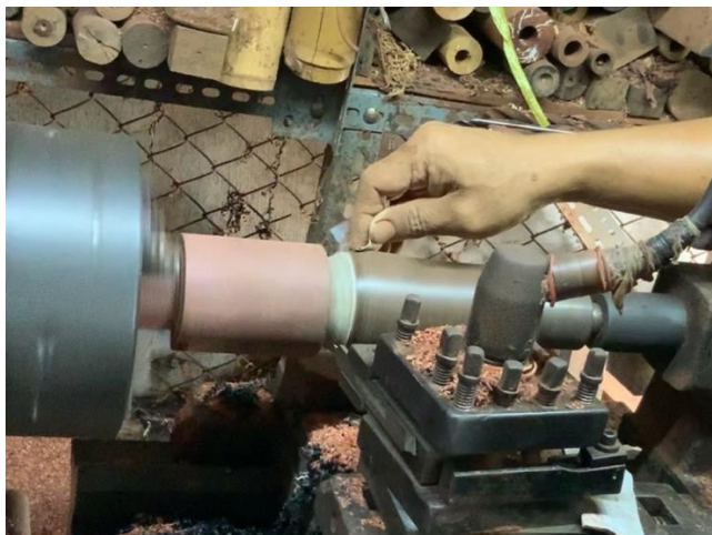
ภาพที่ 221 การนำกระดาษทรายขัดเพื่อให้หนังงูและเนื้อไม้เป็นเนื้อเดียวกัน ที่มา: ศศิตรา ธรรมรัตน์
