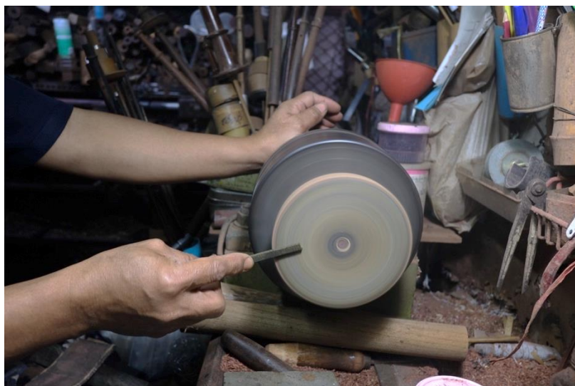
ภาพที่ 241 การขัดเหลาตกแต่งรูปทรงด้วยเครื่องขัด ที่มา: ศศิตรา ธรรมรัตน์
