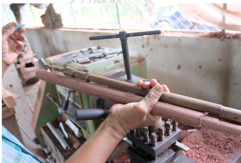
ภาพที่ 142 การนำปากกาขีดจุดให้ตรงกับต้นแบบที่วัดไว้ ที่มา: ศศิตรา ธรรมรัตน์
