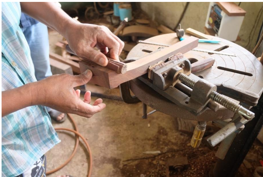
ภาพที่ 119 การนำกระดาษทรายขัดไขนซอเพื่อตกแต่งเก็บรายละเอียดชิ้นงาน ที่มา: ศลิตรา ธรรมรัตน์
