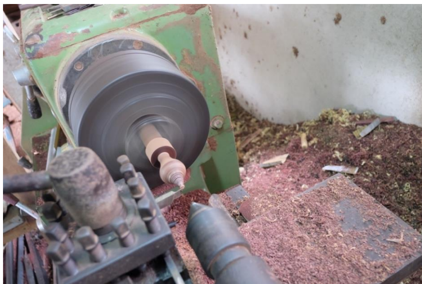
ภาพที่ 154 การกลึงส่วนลูกแก้ว หรือ หัวบัวของลูกบิด ที่มา: ศศิตรา ธรรมรัตน์
