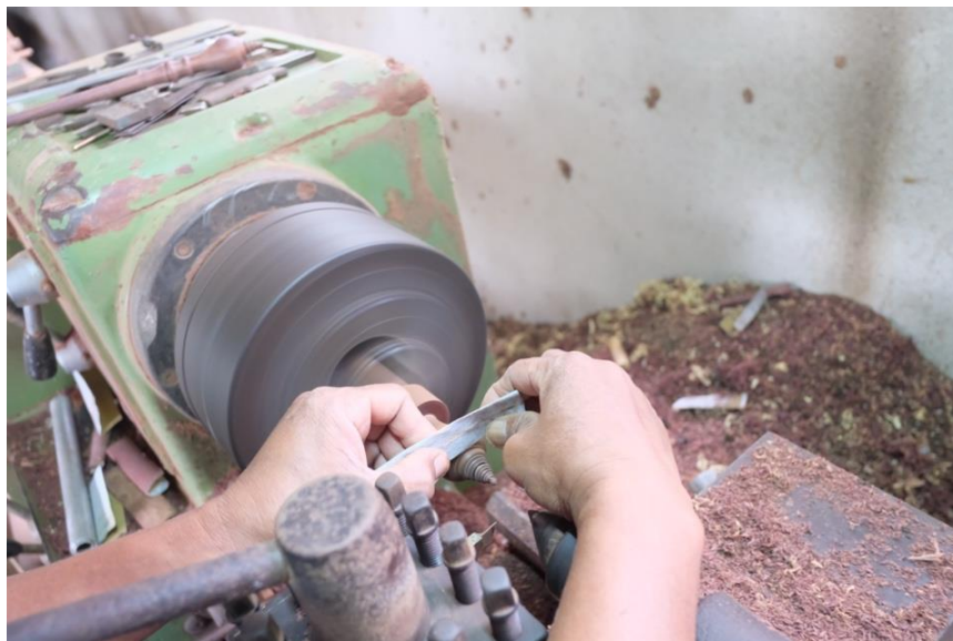
ภาพที่ 156 การขัดกระดาษทรายในส่วนที่กลึงเสร็จ ที่มา: ศศิตรา ธรรมรัตน์
