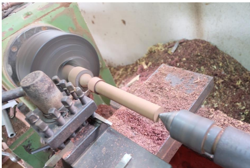
ภาพที่ 157 การกลึงอีกด้านหนึ่งของลูกบิด ที่มา: ศศิตรา ธรรมรัตน์
