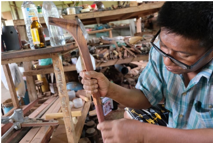
ภาพที่ 148 การนำคันทวนทั้งสองส่วนสวมเข้าด้วยกัน ที่มา: ศศิตรา ธรรมรัตน์
