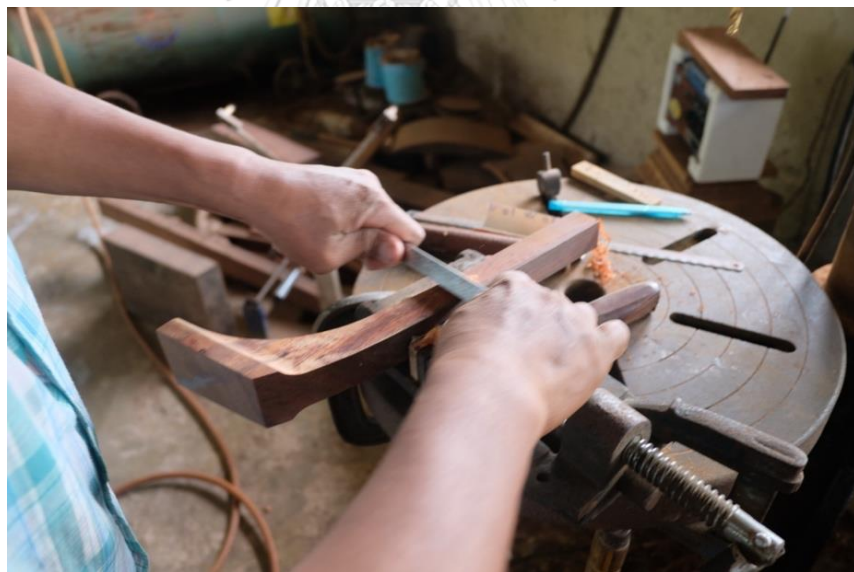
ภาพที่ 118 การนำใบมีดขัดในส่วนของเสี้ยนไม้ออกเพื่อความเรียบเนียน ที่มา: ศศิตรา ธรรมรัตน์
