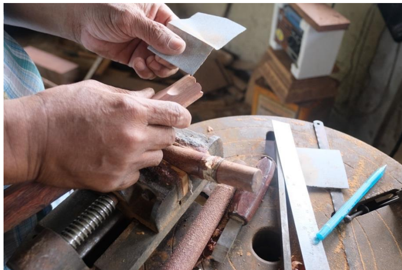
ภาพที่ 131 การนำกระดาษทรายขัดเก็บงานที่ตกแต่ง ที่มา: ศศิตรา ธรรมรัตน์
