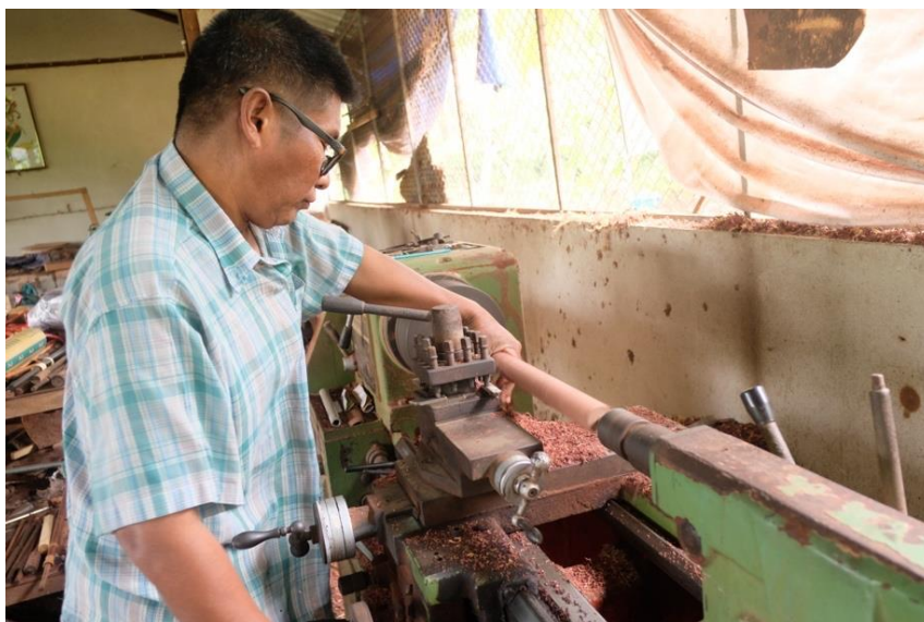
ภาพที่ 139 การนำไม้ขึ้นกลึงบนเครื่องกลึง ที่มา: ศศิตรา ธรรมรัตน์
