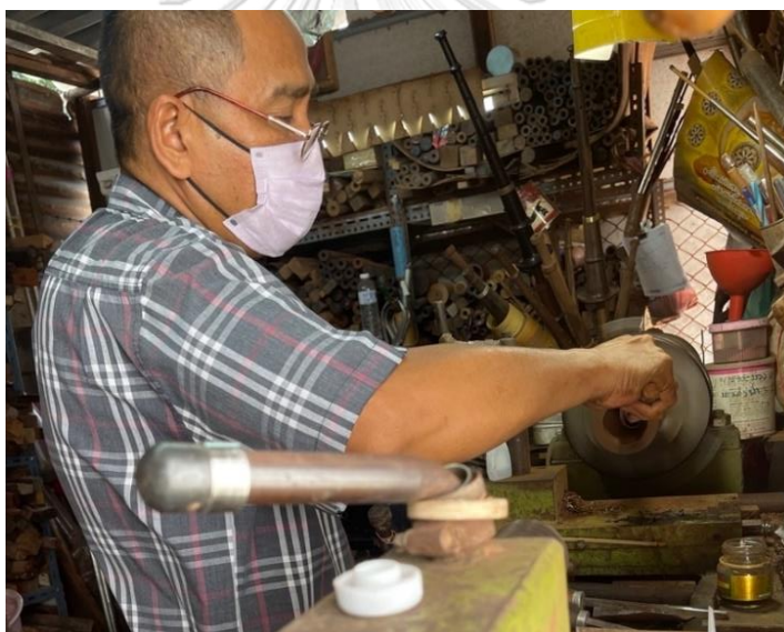
ภาพที่ 274 การกลึงกระบอกซอด้วงด้วยมือ ที่มา: ศศิตรา ธรรมรัตน์
