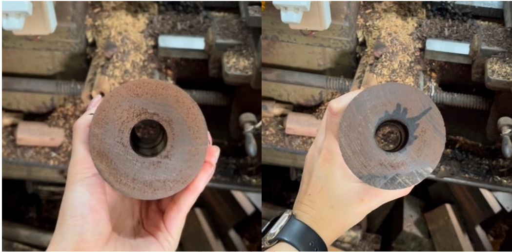
ภาพที่ 185 ท่อนไม้ที่เจาะรูแล้วทั้งสองด้าน
