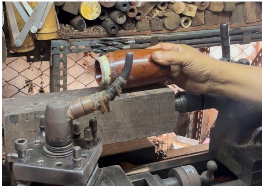
ภาพที่ 179 การนำต้นแบบมาประมาณขนาดของไม้ที่ต้องใช้กลึง ที่มา: ศศิตรา ธรรมรัตน์
