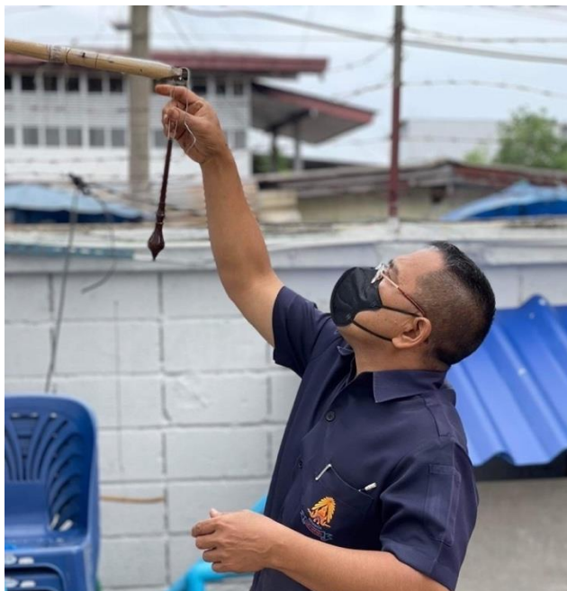
ภาพที่ 225 การนำลูกบิดที่พันแลคเกอร์แล้วแขวนเพื่อตากแดด
