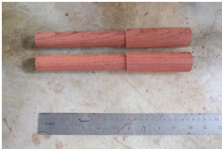
ภาพที่ 150 ไม้ที่นำมากลึงให้เป็นรูปทรงกระบอก เป็นรูปทรงเบื้องต้นของลูกบิด ที่มา: ศลิตรา ธรรมรัตน์
