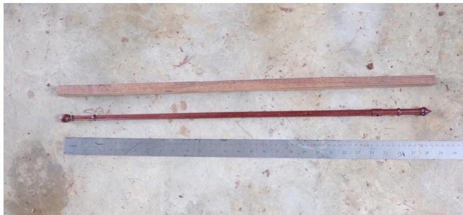
ภาพที่ 279 คันทักสอดดั่งเปรียบเทียบกับขนาดของไม้ก่อนทำการกลึง ที่มา: ศลิตรา ธรรมรัตน์
