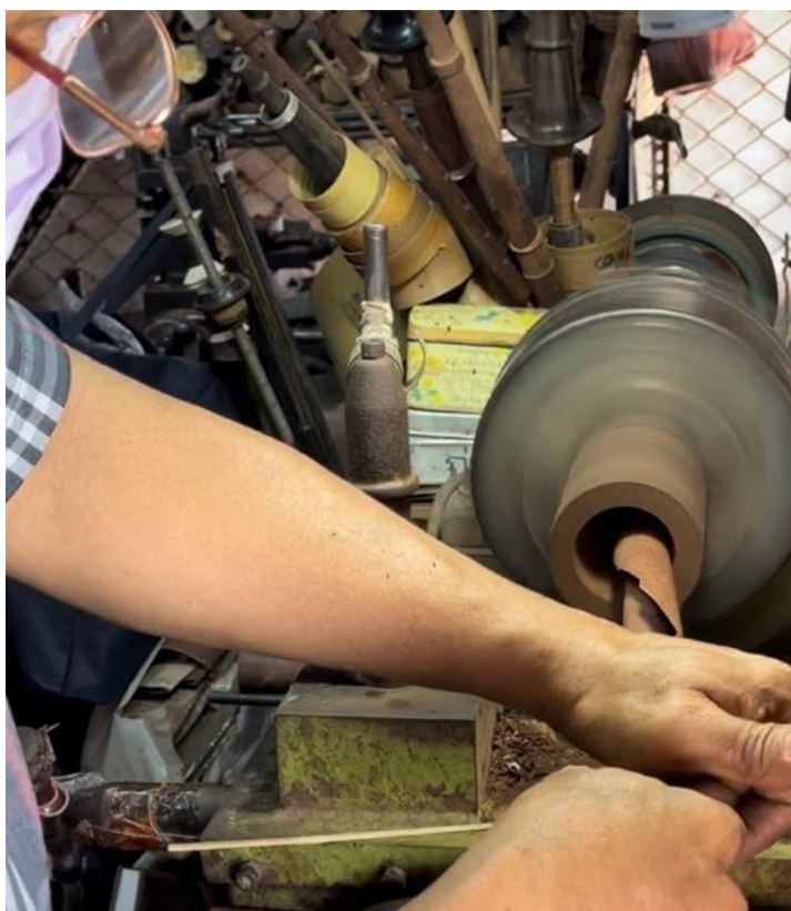
ภาพที่ 194 การนำกระดาษทรายขัดด้านในกระบอกซอ ที่มา: ศศิตรา ธรรมรัตน์
