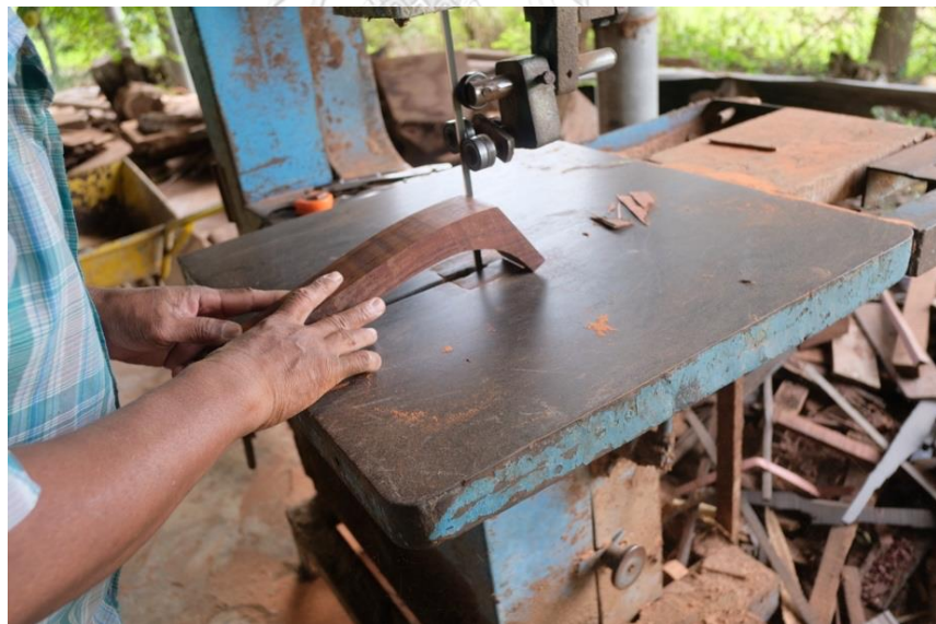
ภาพที่ 116 การนำโขนซอมาเข้าเครื่องเลื่อยไม้ ที่มา: ศศิตรา ธรรมรัตน์
