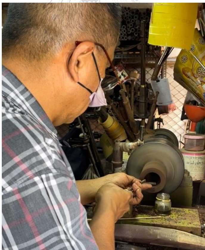
ภาพที่ 193 การนำครอบข้อดุ้งมากลึงด้วยมือด้านในเพื่อเก็บงาน
