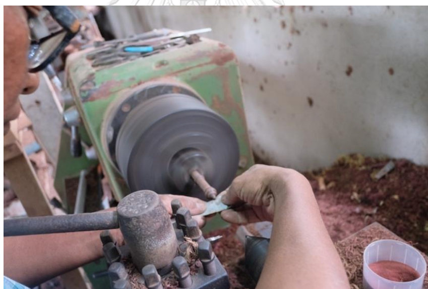
ภาพที่ 169 การขีดกระดาศทรายส่วนของลูกแก้ว ที่มา: ศศิตรา ธรรมรัตน์
