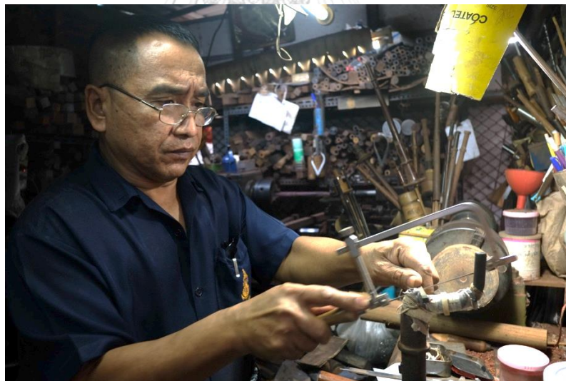
ภาพที่ 240 การเลื่อยไม้ให้เหลือความยาวประมาณ 20-30 เซนติเมตร เพื่อให้สะดวกในการทำงาน ที่มา: ศศิตรา ธรรมรัตน์
