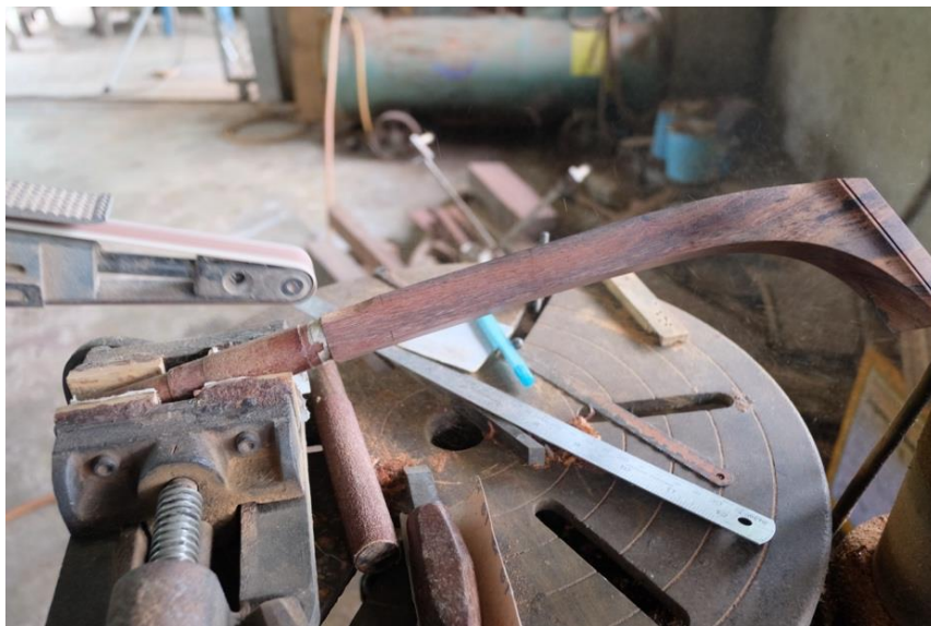
ภาพที่ 129 การนำเครื่องขัดลมเจียรตักแต่งให้เกิดความโค้งมนทั้ง 4 มุม ที่มา: ศศิตรา ธรรมรัตน์
