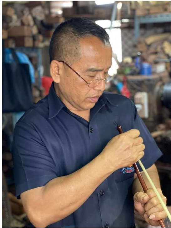
ภาพที่ 235 การนำหางม้ายึดกับหมุดและคันทันชัก
