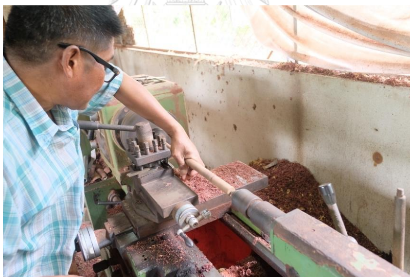
ภาพที่ 163 การกลึงคันทันชักสอดตัวให้เป็นทรงกระบอก ที่มา: ศลิตรา ธรรมรัตน์
