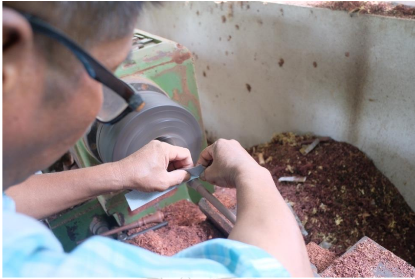
ภาพที่ 159 การขัดกระดาษทรายเพื่อเก็บรายละเอียดงานของลูกบิด ที่มา: ศศิตรา ธรรมรัตน์
