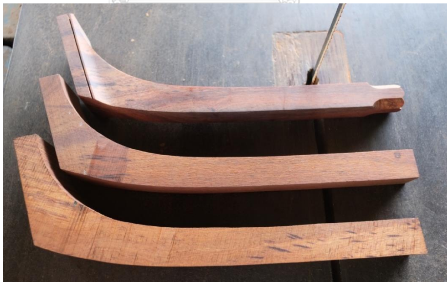
ภาพที่ 276 คันทวนส่วนของโขนซอเรียงตามลำดับการสร้างชิ้นงาน
