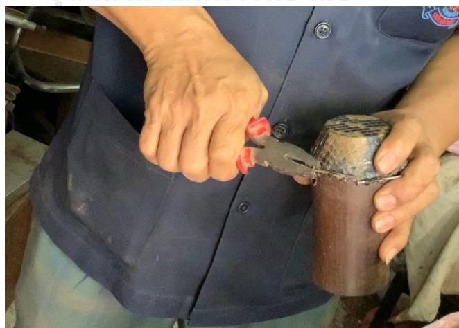
ภาพที่ 218 การดึงตะปูออกจากหนังงู
