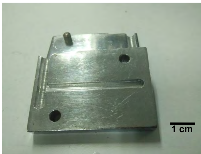
รูปที่ 3.3 แม่พิมพ์สำหรับฉีดขึ้นรูปชิ้นงาน
