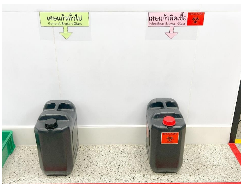
ภาพที่ 4-25 ภาชนะสำหรับรองรับเศษแก้วทั่วไปและเศษแก้วติดเชื้อภายในห้องปฏิบัติการเคมีคลินิก
