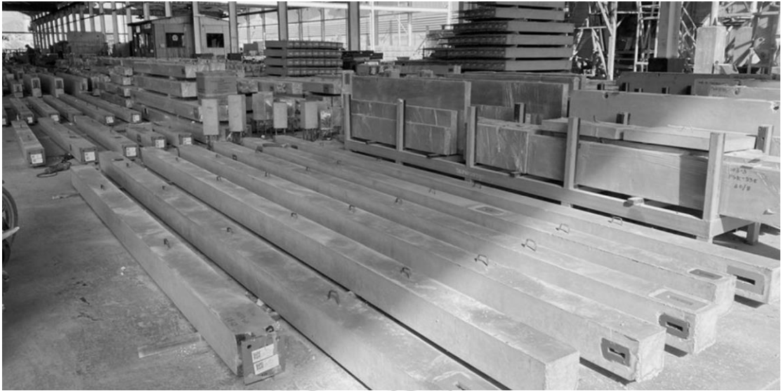
ภาพที่ 16 ชั้นส่วนเสา และคานคอนกรีตสำเร็จรูป
