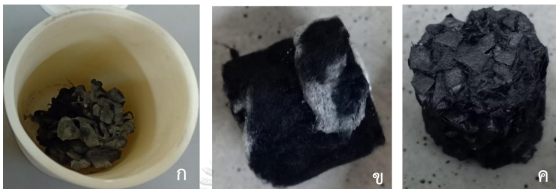
รูปที่ 4.13 ลักษณะของผลิตภัณฑ์ (ก) ที่ได้จากการแคลไซน์ส่วนผสม SBA4 ที่อุณหภูมิ 700 องศาเซลเซียส 2 ชั่วโมง (ข) หลังการสังเคราะห์ และ (ค) หลังการสังเคราะห์โดยไม่ผ่านขั้นตอนแคลไซน์
