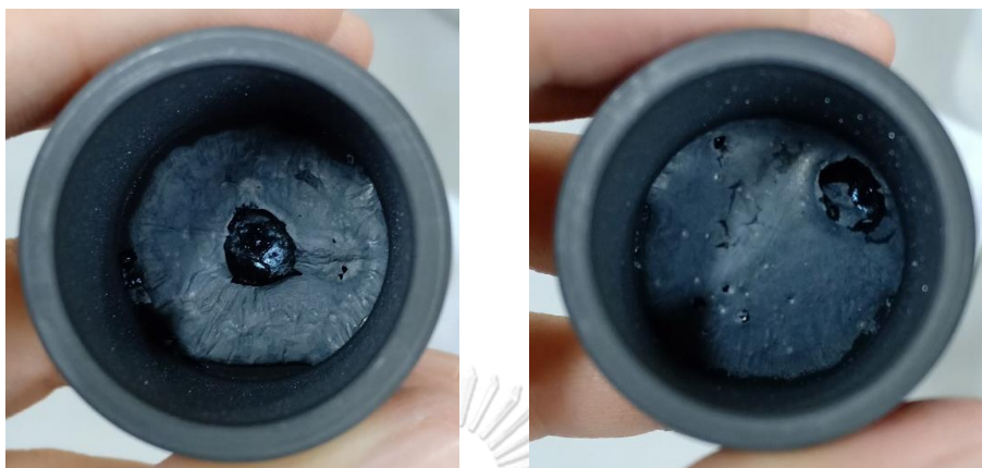
รูปที่ 4.6 ลักษณะของผลิตภัณฑ์จากการเตรียมสารตั้งต้น ด้วยการจุ่มแช่รังไหม 4 กรัม ในสารละลายกรดบอริก และผ่านการสังเคราะห์ที่ 1450 องศาเซลเซียส ภาพซ้าย-จุ่มแช่ ณ อุณหภูมิห้อง และภาพขวา-จุ่มแช่ที่อุณหภูมิ 80 องศาเซลเซียส
