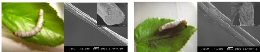
รูปที่ 2.17 (ซ้าย) ภาพตัดขวางของเส้นไหมปกติ และ(ขวา) เส้นไหมจากหนอนไหมที่เสริมอาหารด้วยคาร์บอนนาโนทิวป์ [17]
