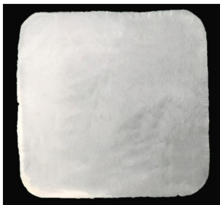
รูปที่ 3.2 แผ่นแบคทีเรียเซลลูโลส-กราฟต์-พอลิเมทิลเมทาคริเลต
