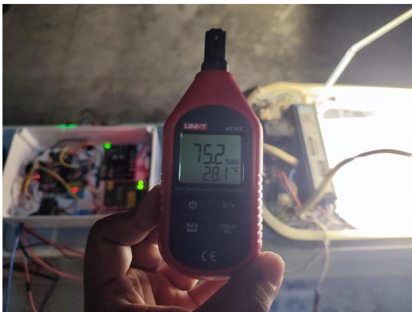
รูปที่ 43 ตัวอย่างการทดสอบการวัดค่าความชื้นและอุณหภูมิผ่าน UT333 ตารางที่ 30 เปรียบเทียบผลการวัดอุณหภูมิ AM2302 Module กับ UT333
