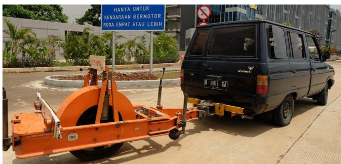
รูปที่ 23 การวัด IRI โดยใช้ Bump Integrator
