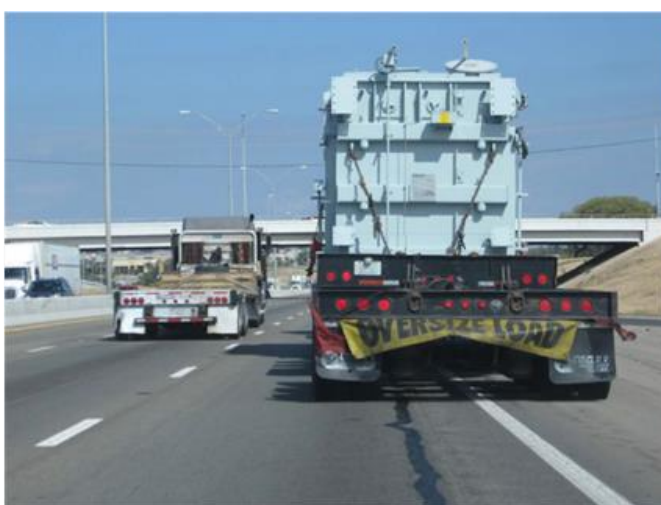
รูปที่ 10 Super-Heavy Load Transporter with Transformer on IH 35 NB Main Lanes— Austin
