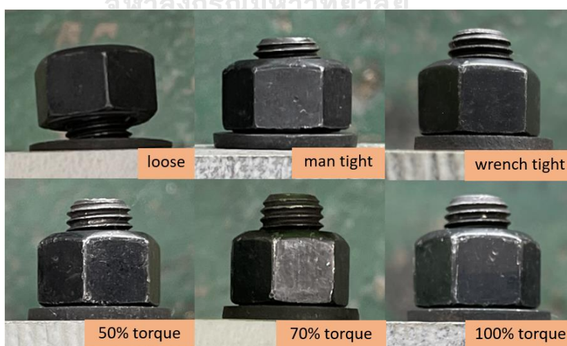
รูปที่ 17 การขันสลักเกลียว M16 ที่ระดับแรงบิดต่าง ๆ
