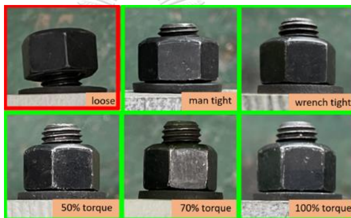
รูปที่ 26 วิธีคัดแยกสลักเกลียว M16 แบบประเภทชั้นแน่น
