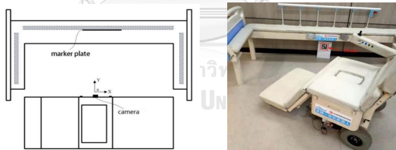
รูปที่ 6 การติดตั้งกล้องและArUco
