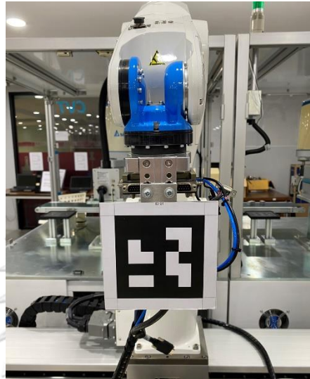
รูปที่ 21 ติดตั้ง ArUco end effector กับ articulated robot
