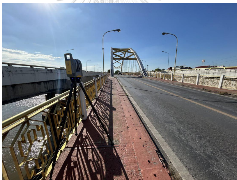
รูปที่ 3.23 กล้องสำรวจ 3D laser scanner Trimble X7
